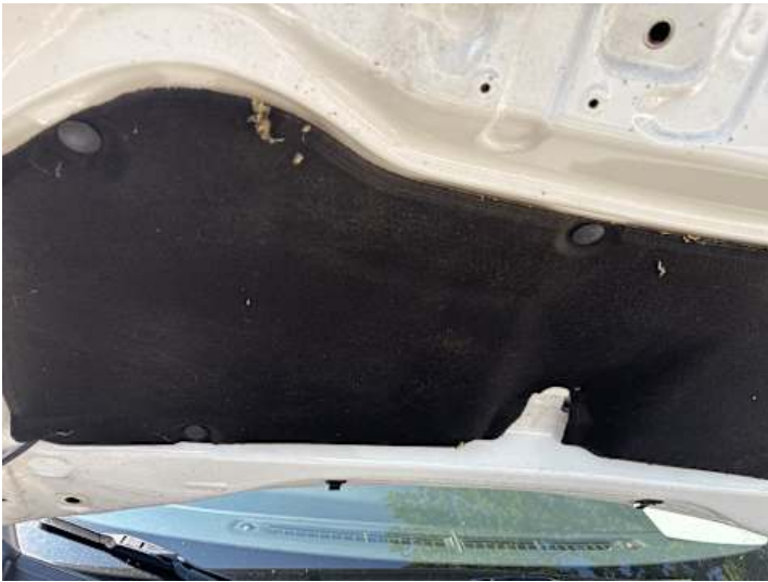
Motorhaube (Anderer Schaden): Dämmung beschädigt
