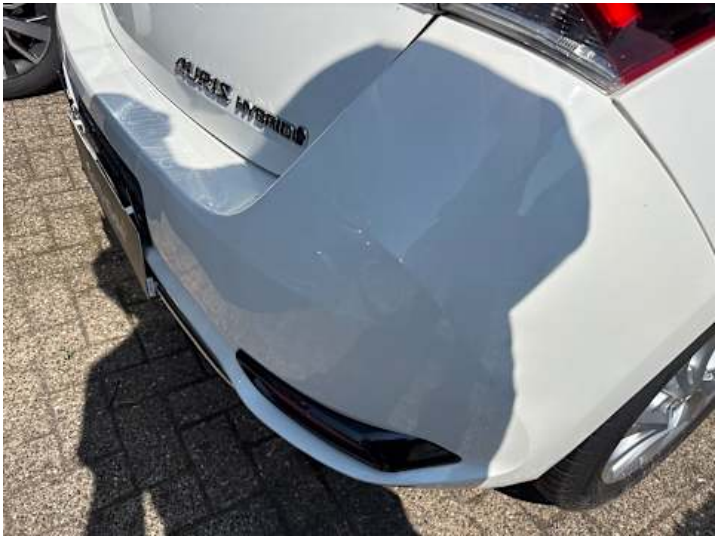
Stoßstange hinten (Spaltmaße ungenau)
