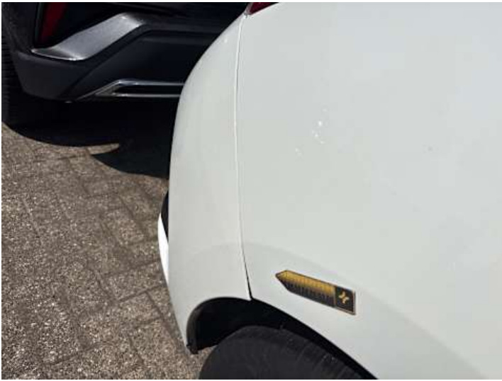
Stoßstange hinten (Spaltmaße ungenau)
