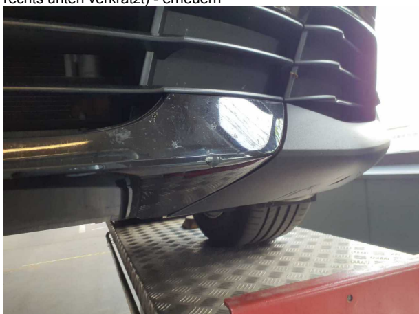
Beschädigung 6: Stossfänger vorn: Spoiler - verformt - lackieren
