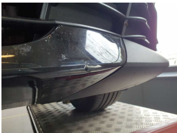
Beschädigung 6: Stossfänger vorn: Spoiler - verformt - lackieren
