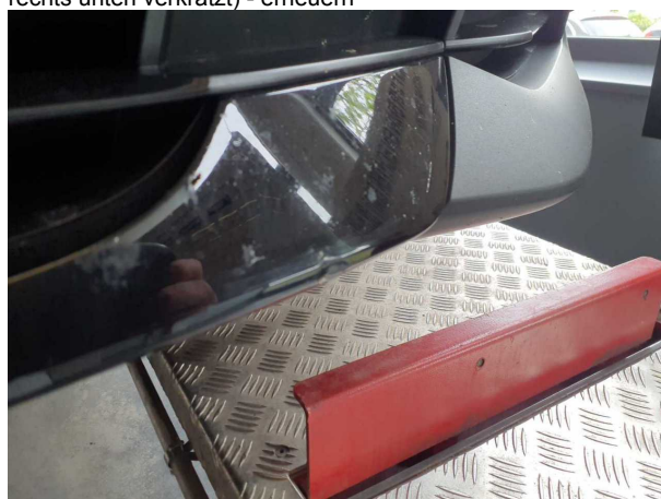
Beschädigung 6: Stossfänger vorn: Spoiler - verformt - lackieren
