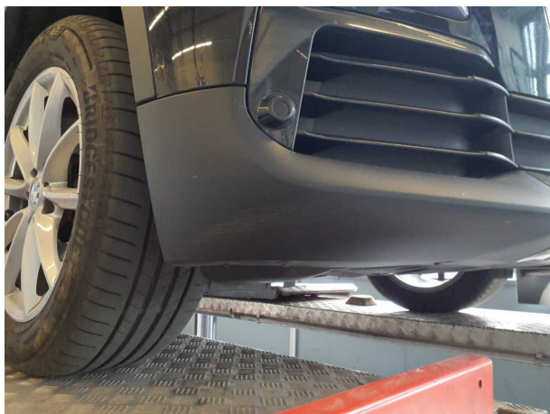
Beschädigung 5: Stossfänger vorn: Stossfänger vorn (Blende rechts unten verkratzt) - erneuern
