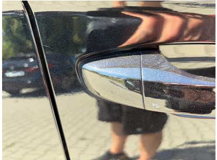
Beifahrtür (Kratzer, Lackschaden)
