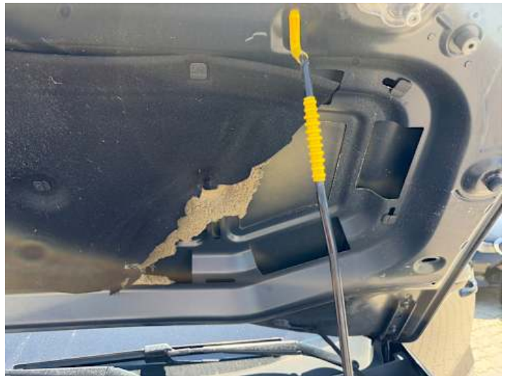
Motorhaube (Riss/Bruch, Anderer Schaden): Marderspuren
