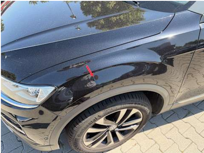
Kotflügel vorne links (Kratzer, Lackschaden)
