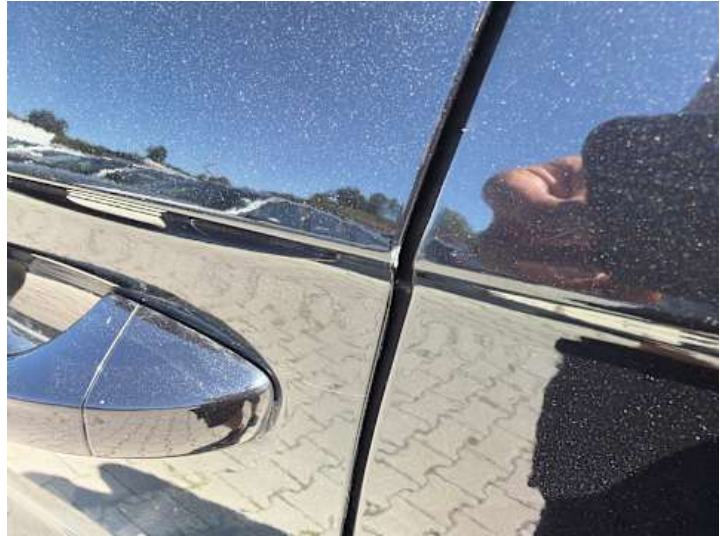
Fahrtür (Kratzer, Lackschaden)
