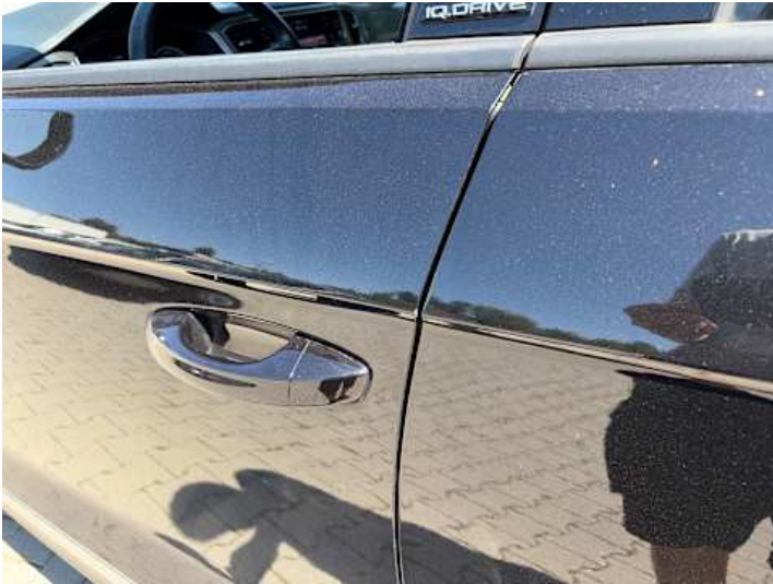
Fahrtür (Kratzer, Lackschaden)
