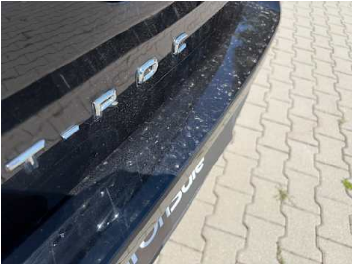
Stoßstange hinten (Kratzer, Lackschaden)
