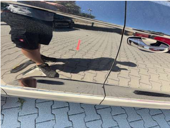
Türe hinten rechts (Lackschaden)
