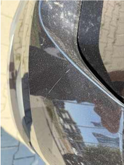
Stoßstange hinten (Kratzer, Lackschaden)
