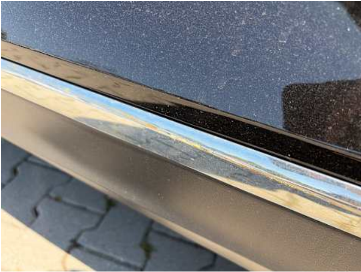
Türe hinten links (Kratzer, Lackschaden)
