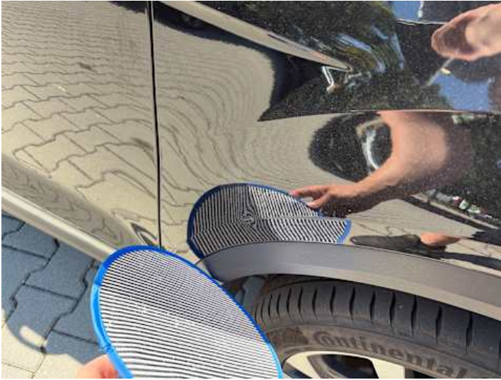
Kotflügel vorne rechts (Delle, Kratzer, Lackschaden)
