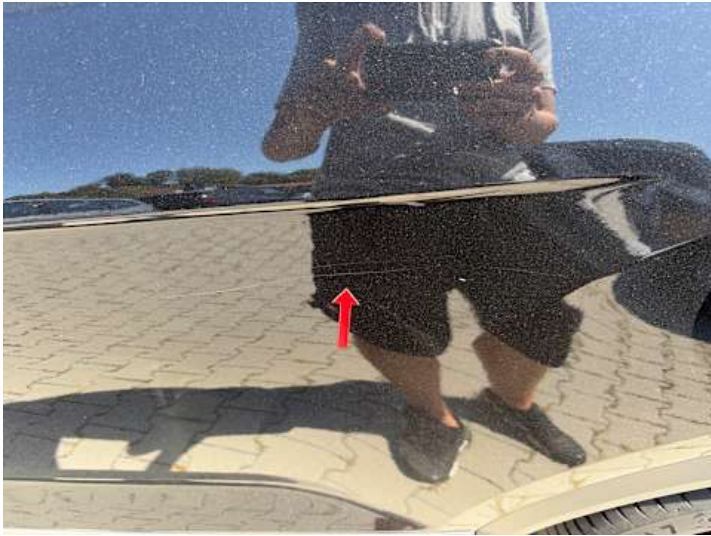
Türe hinten links (Kratzer, Lackschaden)
