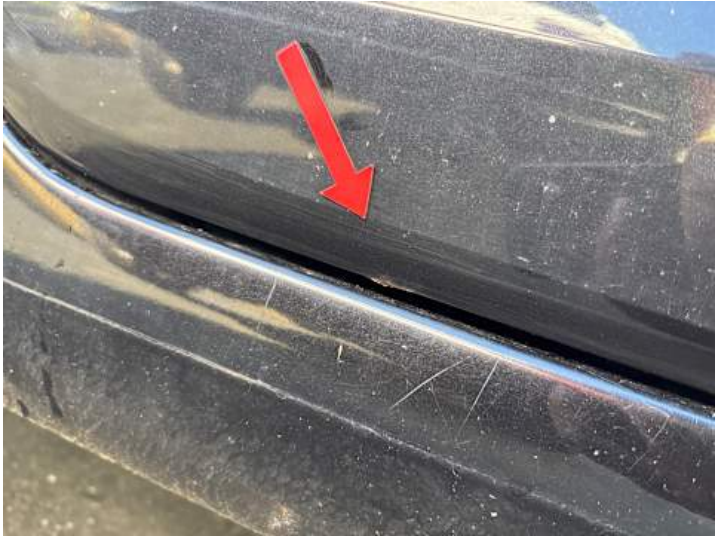
Türe hinten rechts (Rost)
