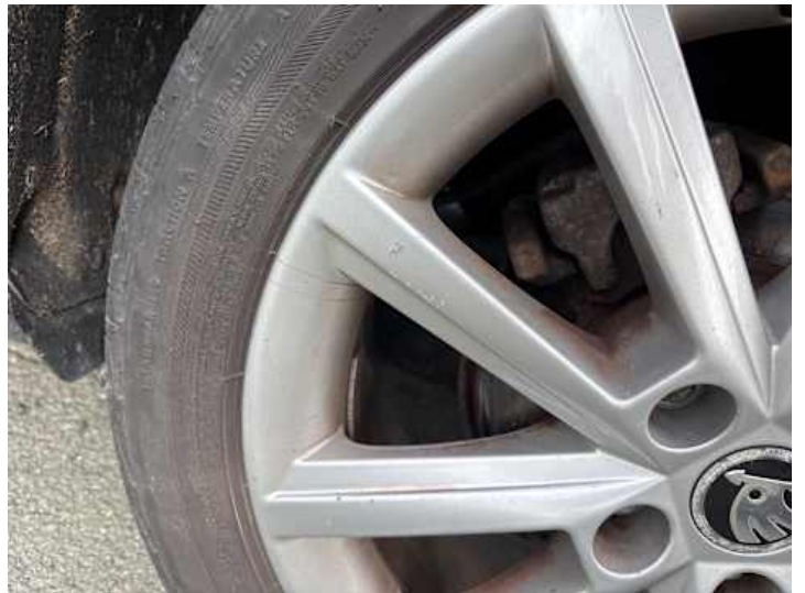
Rad (Anderer Schaden, Kratzer): Lackschaden
