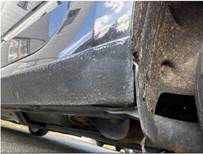
Schweller links (Verformung)
