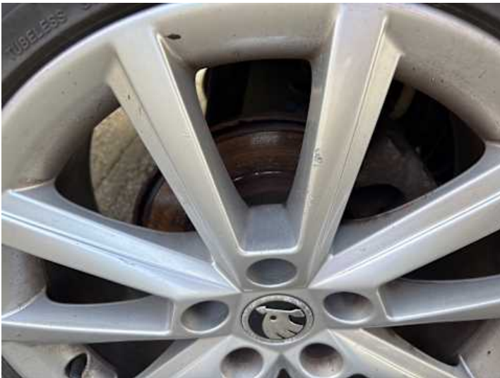
Rad (Kratzer, Anderer Schaden): Lackschaden
