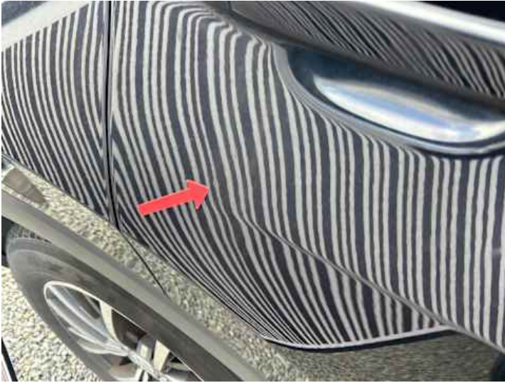
Türe hinten rechts (Delle)
