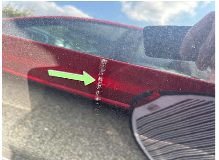
Türe hinten links (Kratzer)
