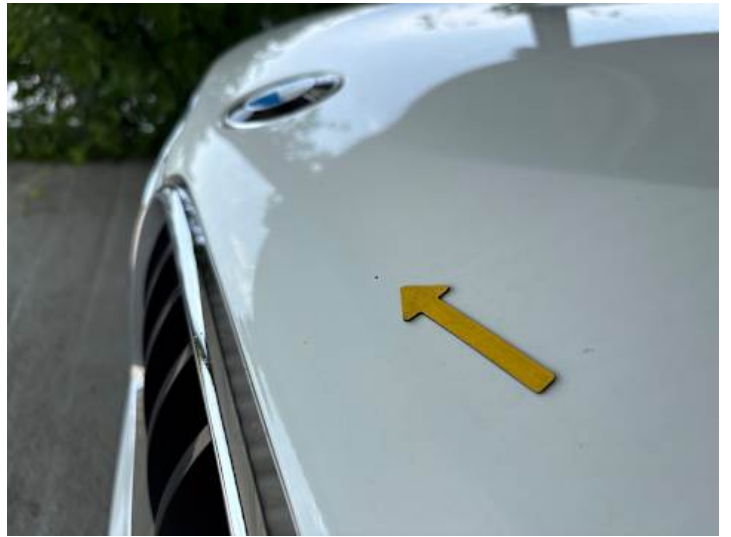
Motorhaube (Steinschlag, Rost)
