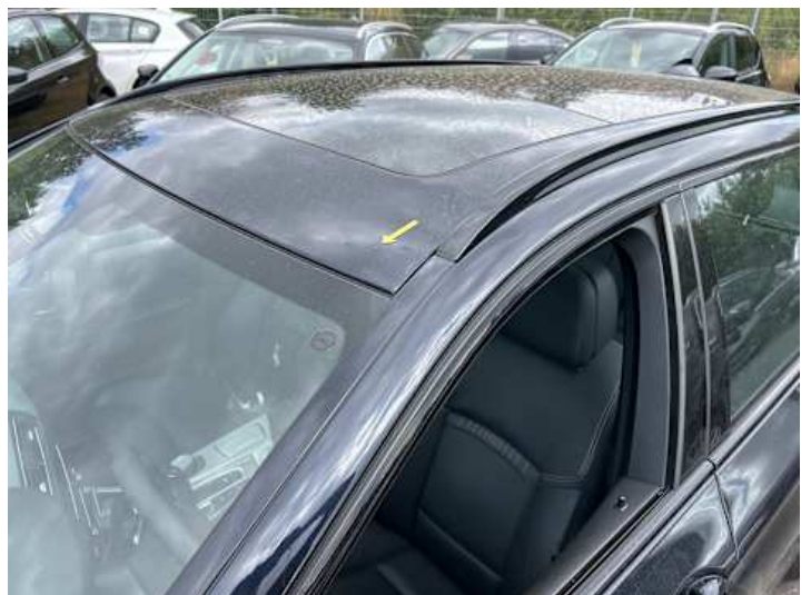
Dach (Lackschaden, Steinschlag)
