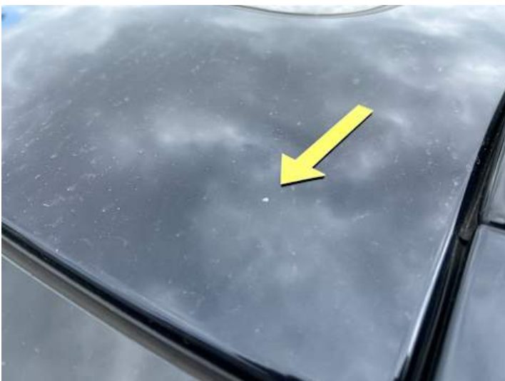
Dach (Lackschaden, Steinschlag)
