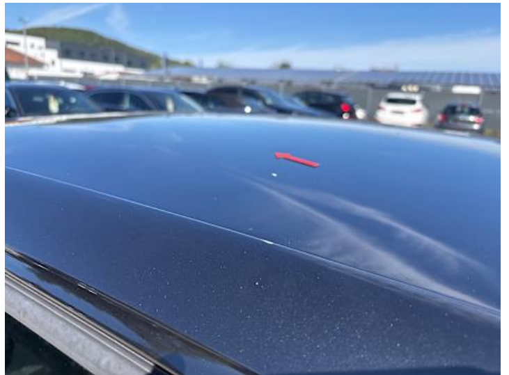
Dach (Lackschaden, Unsachgemäß instand gesetzt, Kratzer)
