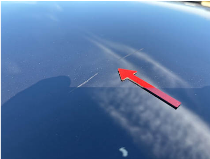
Dach (Lackschaden, Unsachgemäß instand gesetzt, Kratzer)
