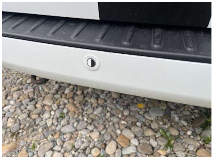
Stoßstange hinten (Lackschaden, Verformung)
