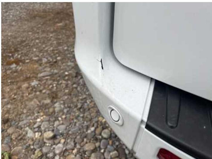
Stoßstange hinten (Lackschaden, Verformung)
