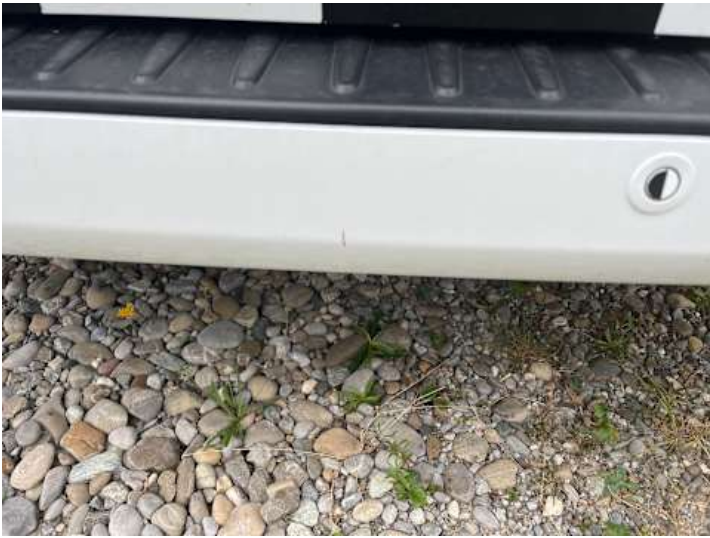
Stoßstange hinten (Lackschaden, Verformung)
