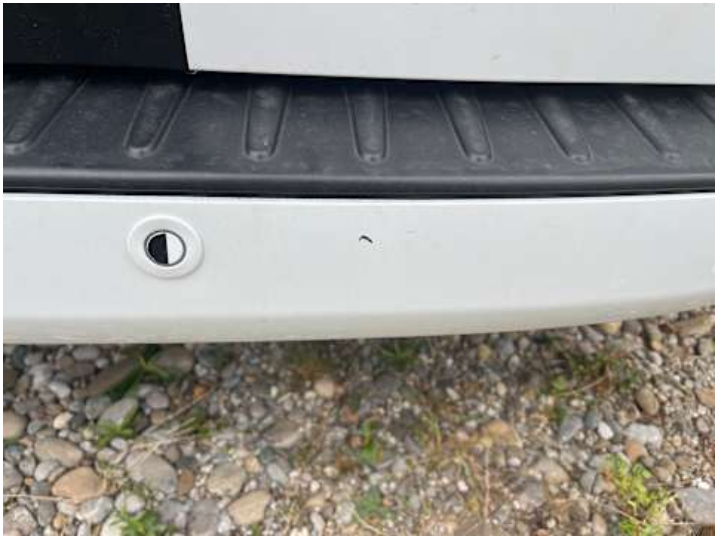
Stoßstange hinten (Lackschaden, Verformung)
