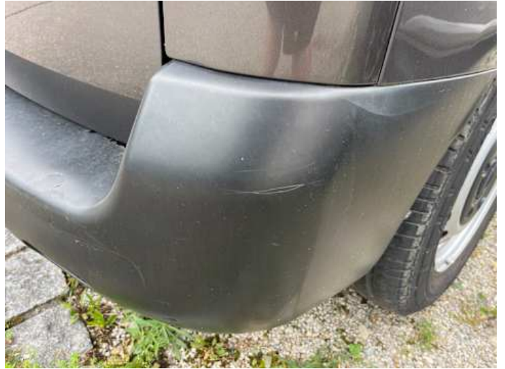
Stoßstange hinten (Kratzer)
