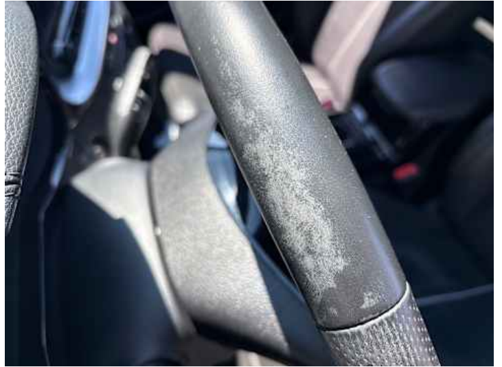
Innenraum (Verschmutzung, Verschleiß)
