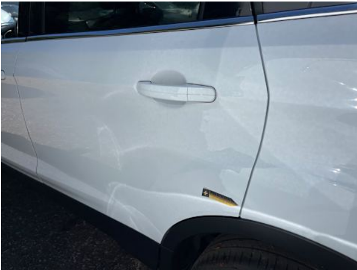
Türe hinten links (Lackschaden)
