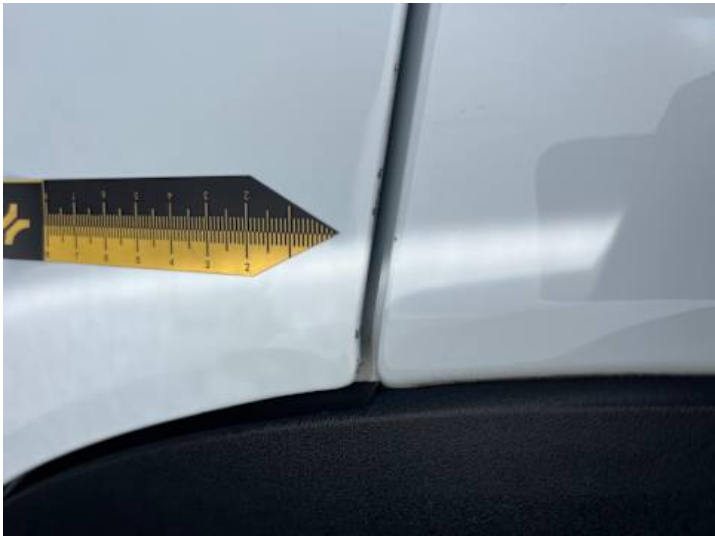
Türe hinten links (Lackschaden)
