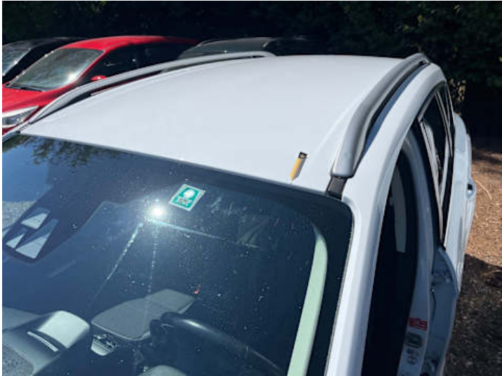
Dach (Steinschlag, Unsachgemäß instand gesetzt)
