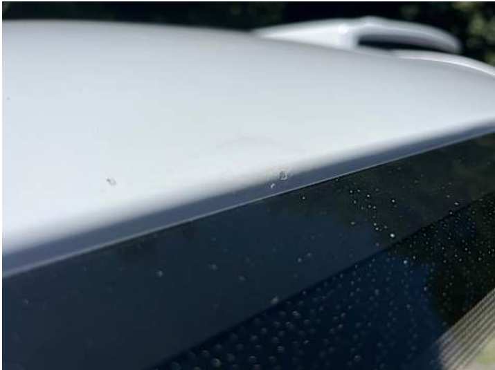
Dach (Steinschlag, Unsachgemäß instand gesetzt)
