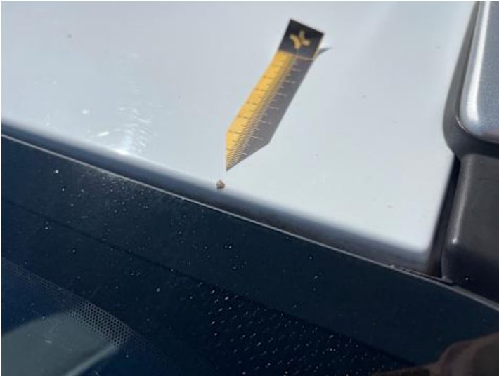
Dach (Steinschlag, Unsachgemäß instand gesetzt)
