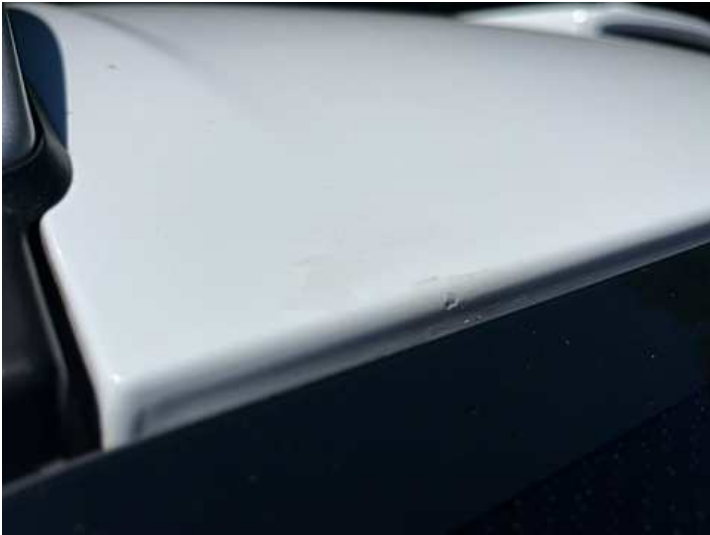
Dach (Steinschlag, Unsachgemäß instand gesetzt)
