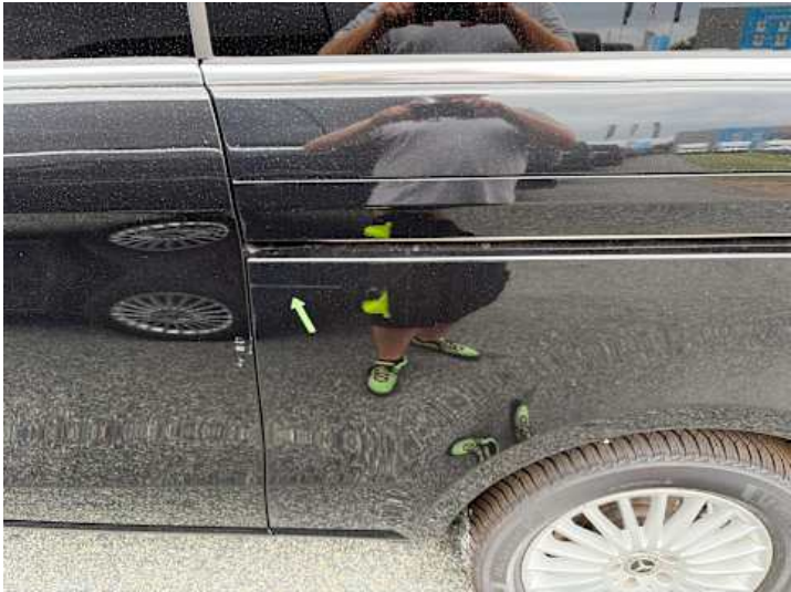
Seitenteil hinten links (Kratzer)
