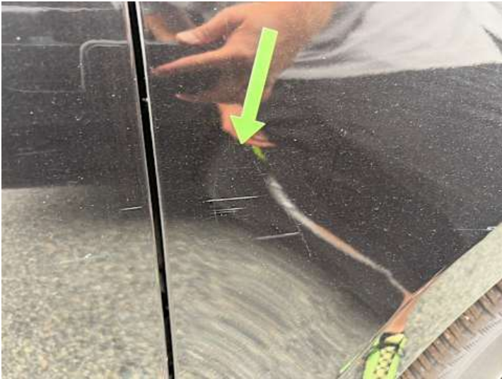
Kotflügel vorne rechts (Kratzer)
