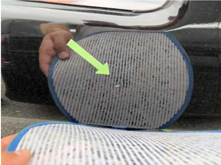
Kotflügel vorne rechts (Delle)
