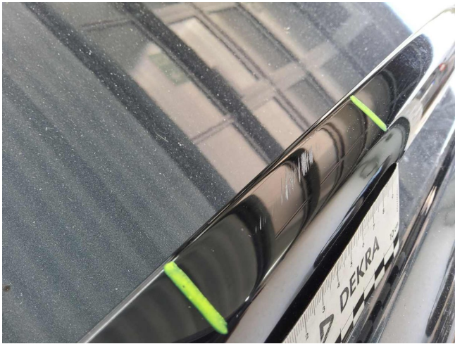
Dachreling links verkratzt (DEKRA)
