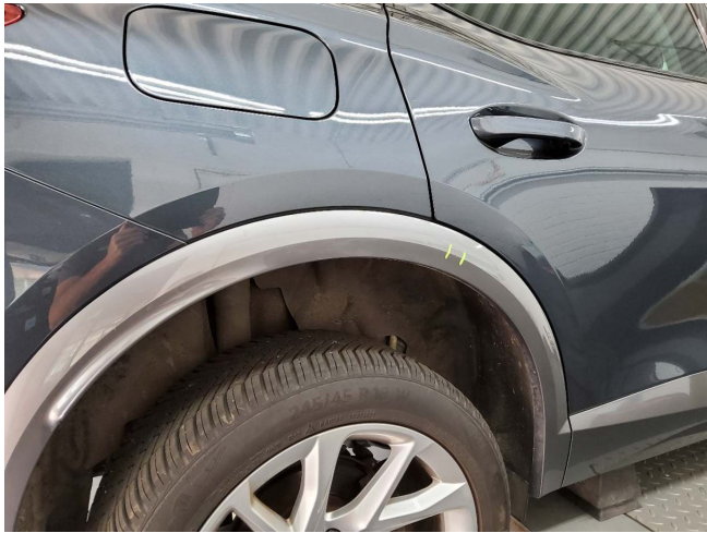
Radlaufabdeckung hinten rechts verschrammt (DEKRA)
