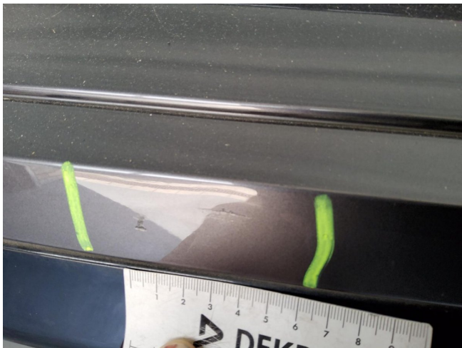
Stoßfänger hinten Lackierung, verschrammt, smart repair (DEKRA)
