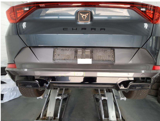
Stoßfänger hinten Lackierung, verschrammt, smart repair (DEKRA)
