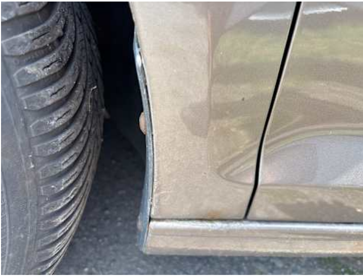
Kotflügel vorne links (Rost)
