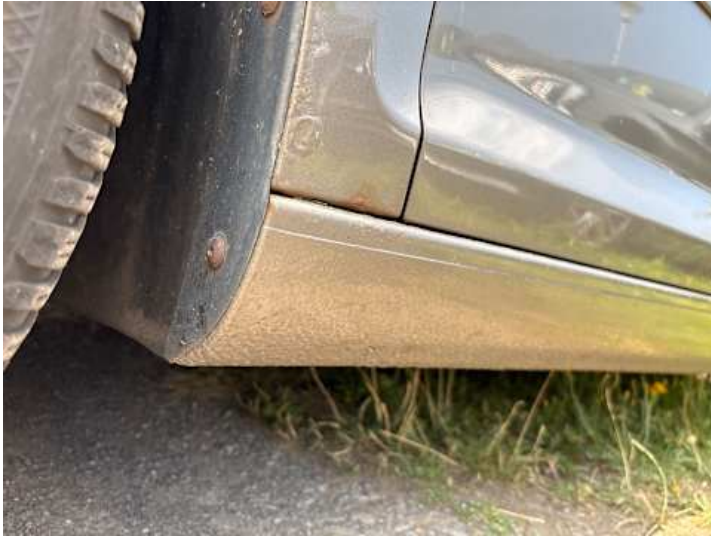
Schweller links (Rost)
