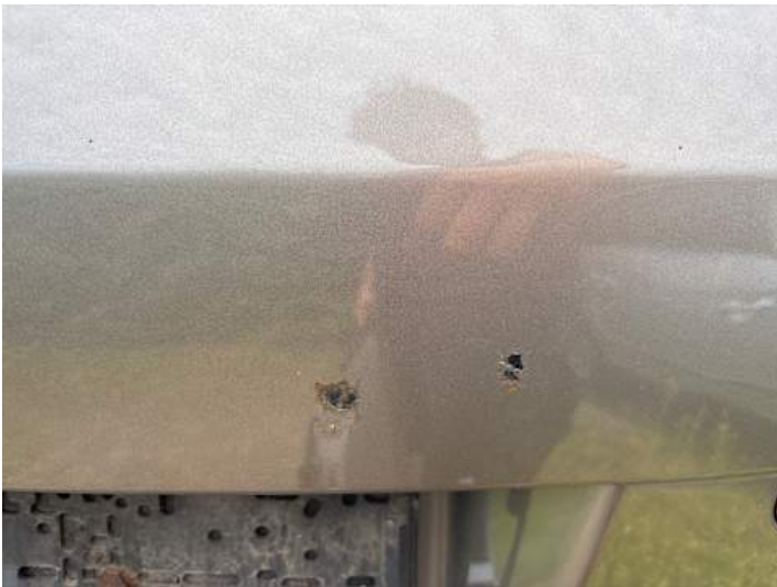
Heckklappe (Kratzer, Rost)
