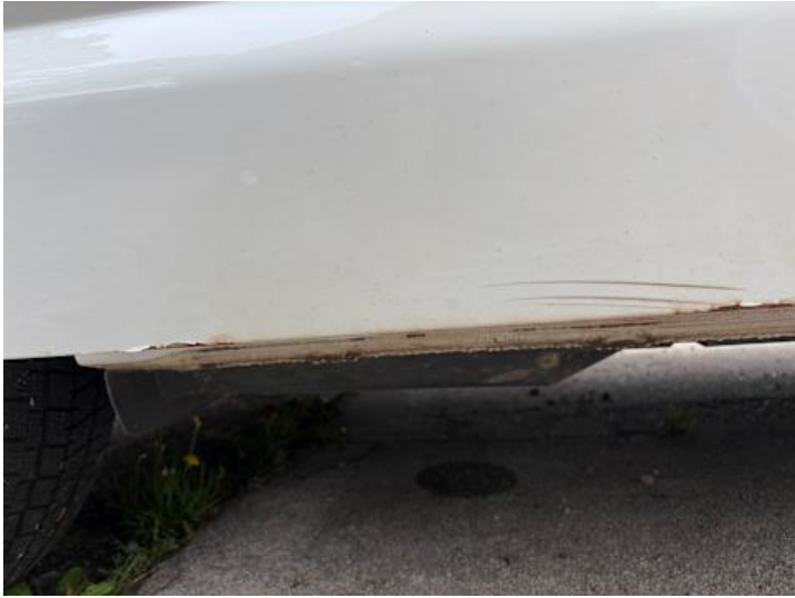
Türe hinten rechts (Kratzer, Lackschaden, Verformung, Rost)
