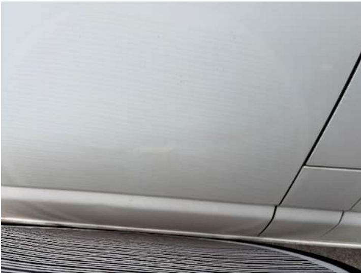
Fahrertür (Delle, Verformung)
