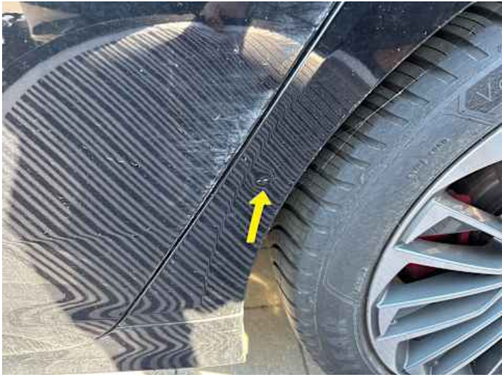
Seitenteil hinten links (Delle, Kratzer, Lackschaden)
