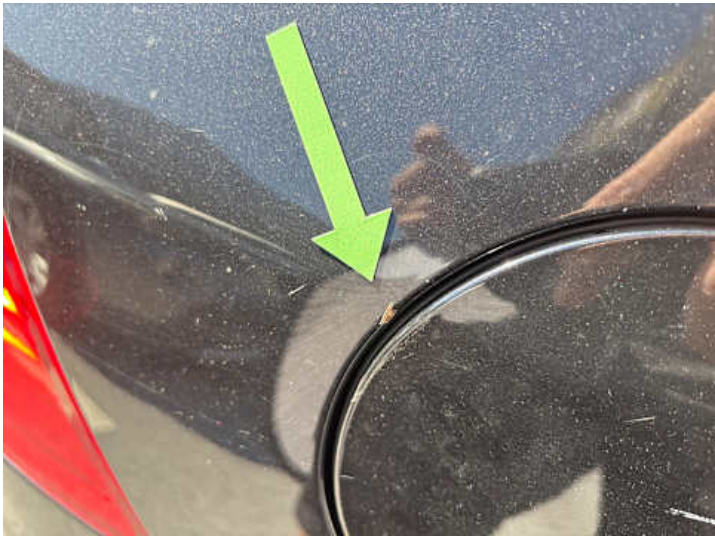
Seitenteil hinten rechts (Rost)
