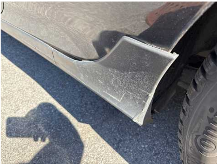
Schweller links (Verformung, Kratzer, Spaltmaße ungenau)
