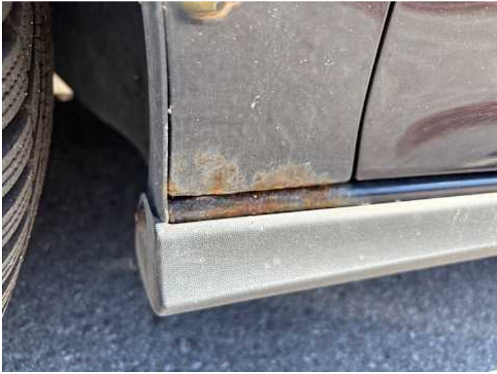
Schweller links (Rost)
