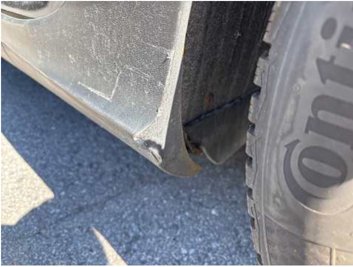
Schweller links (Rost)
