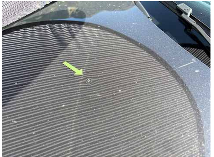
Motorhaube (Delle, Lackschaden)
