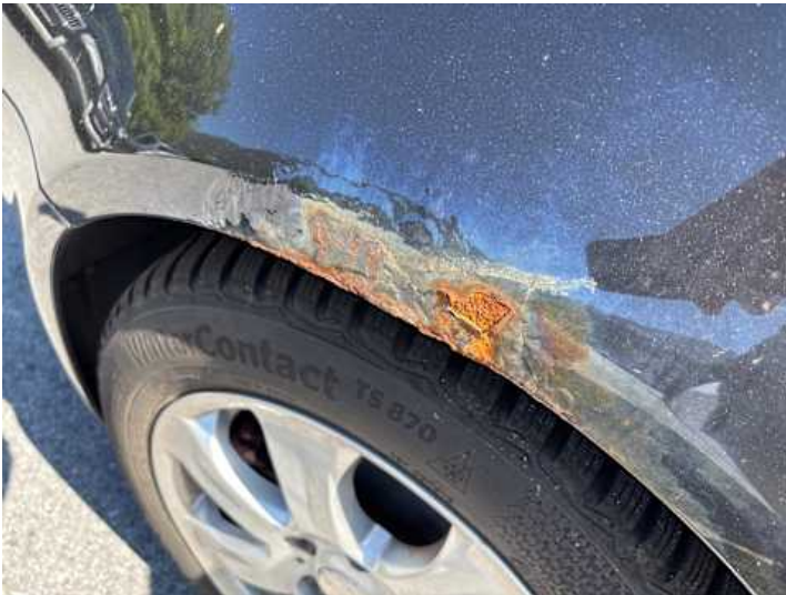
Kotflügel vorne links (Rost)
