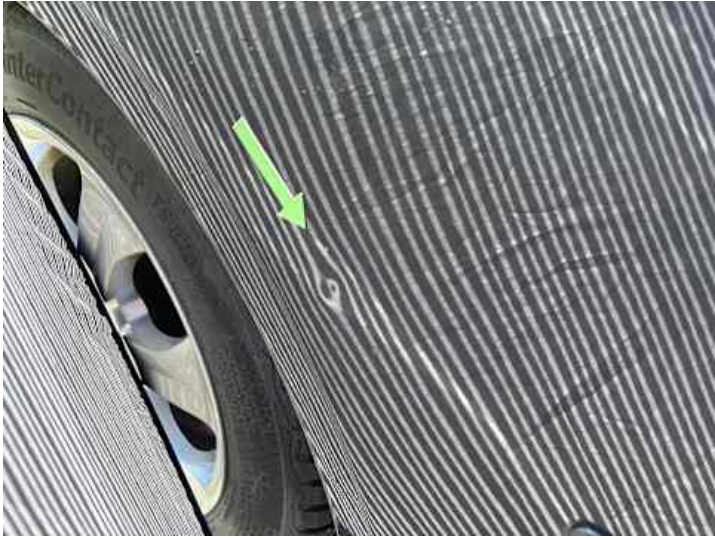
Seitenteil hinten rechts (Delle)
