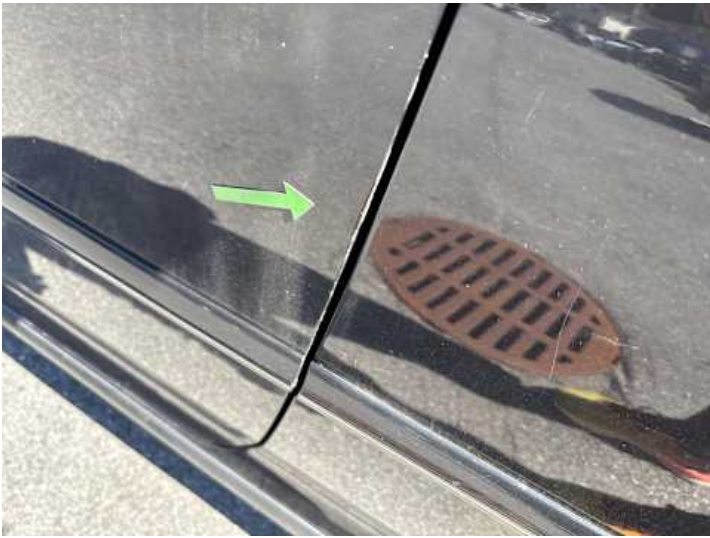
Fahrtür (Lackschaden, Delle)
