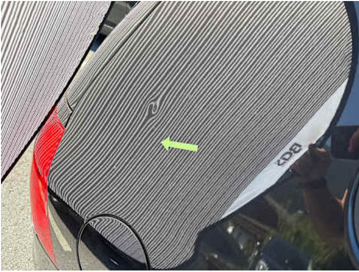
Seitenteil hinten rechts (Delle)
