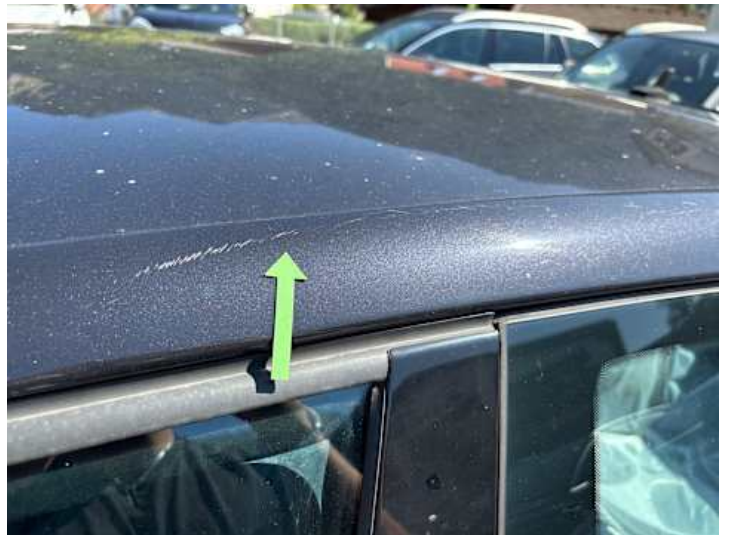
Seitenteil hinten links (Kratzer)
