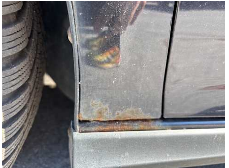
Kotflügel vorne links (Rost)
