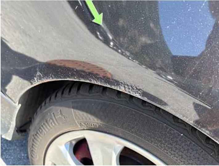
Seitenteil hinten links (Rost)
