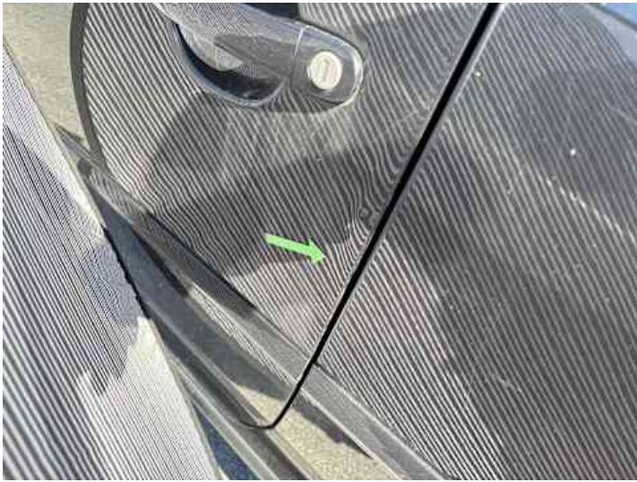
Fahrtür (Lackschaden, Delle)
