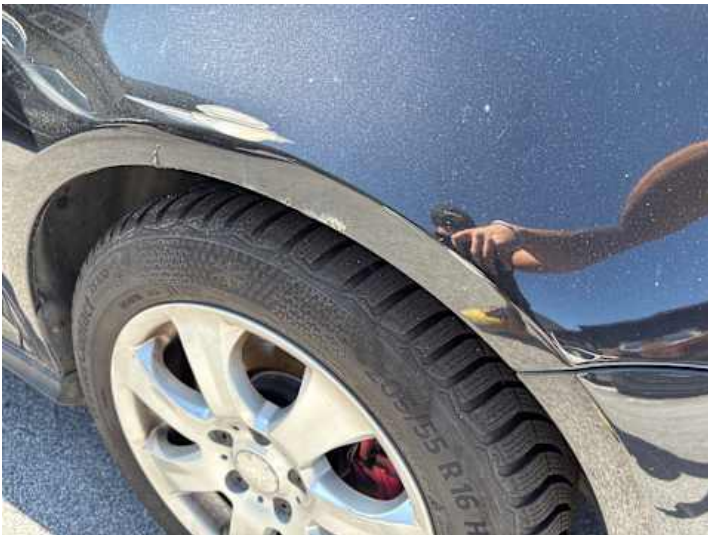
Kotflügel vorne rechts (Kratzer, Lackschaden, Rost)
