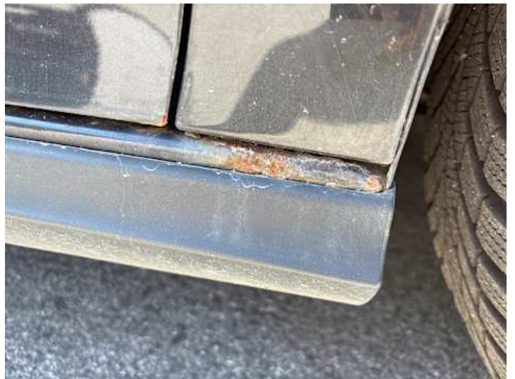
Schweller rechts (Rost)
