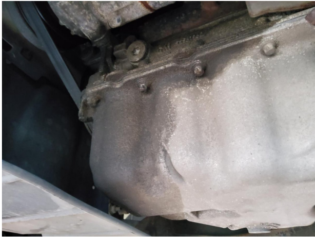
Motor - Ölundichtigkeit / prüfen
