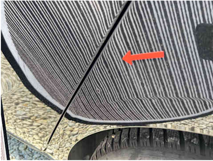
Seitenteil hinten links (Delle)
