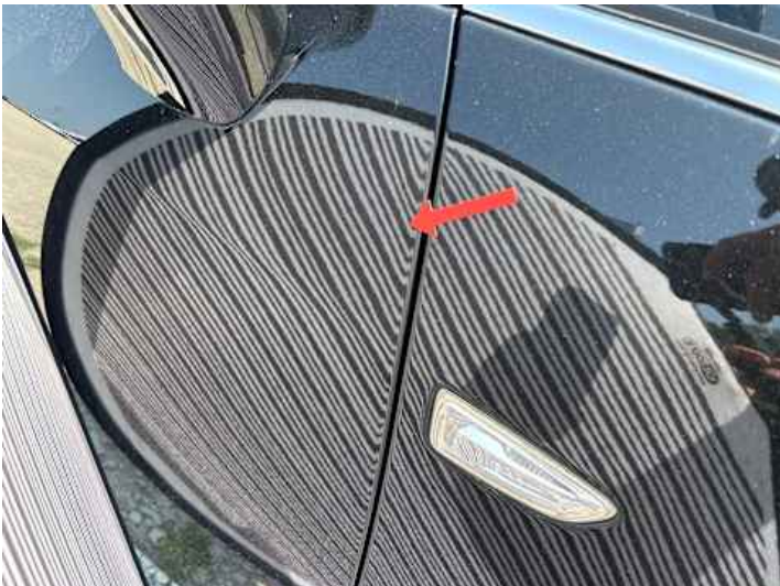
Beifahrertür (Unsachgemäß instand gesetzt)
