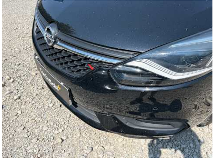
Stoßstange vorne (Spaltmaße ungenau)
