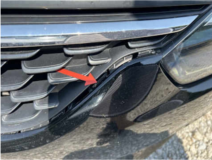
Stoßstange vorne (Spaltmaße ungenau)
