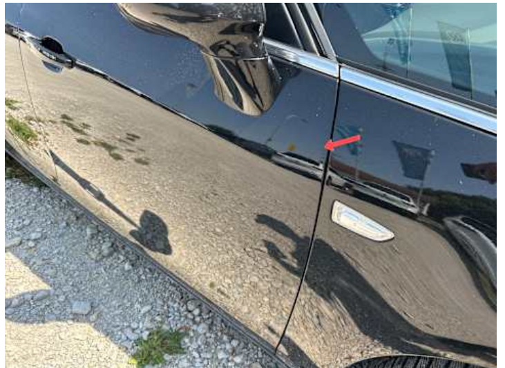
Beifahrertür (Unsachgemäß instand gesetzt)
