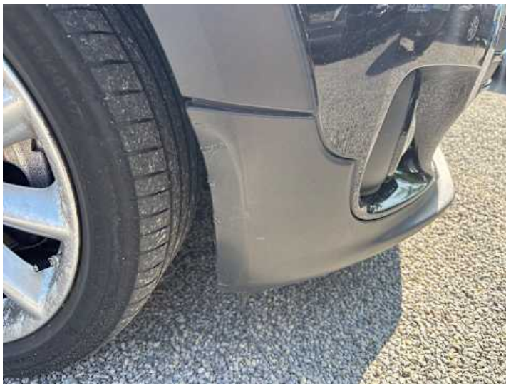
Stoßstange vorne (Verformung)
