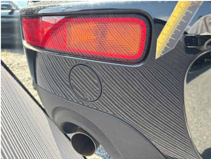
Stoßstange hinten (Unsachgemäß instand gesetzt)
