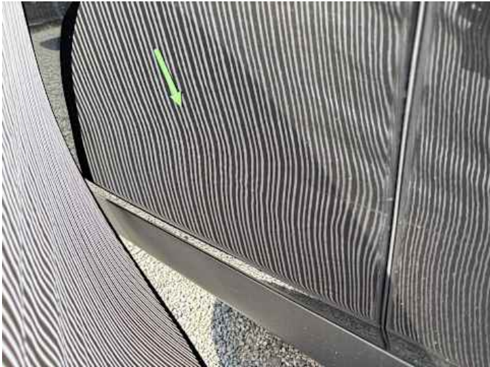
Fahrtür (Unsachgemäß instand gesetzt)
