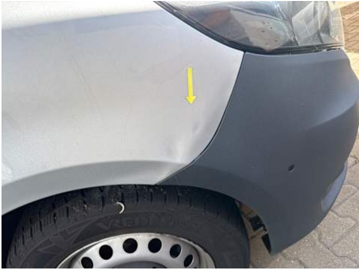
Kotflügel vorne rechts (Verformung, Spaltmaße ungenau)
