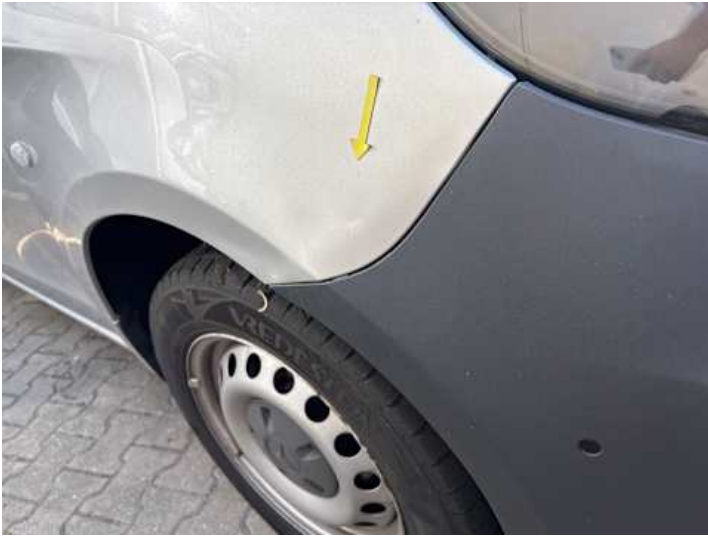
Kotflügel vorne rechts (Verformung, Spaltmaße ungenau)
