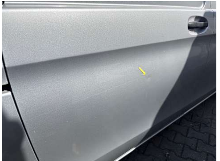
Türe hinten rechts (Delle, Kratzer)
