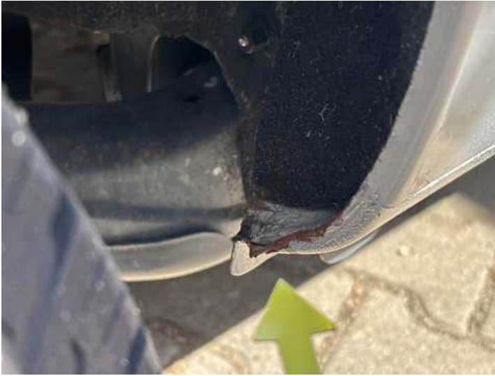
Schweller rechts (Rost)
