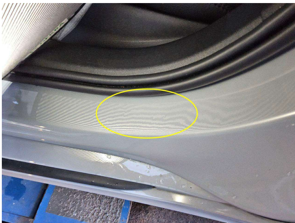
Bild 10 : Türeinstieg hinten links eingedellt
