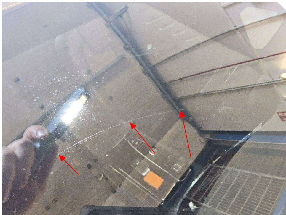
Bild 16 : Frontscheibe mehrere tiefe Kratzer
