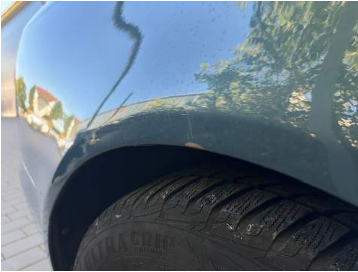
Seitenteil hinten rechts (Kratzer, Rost)
