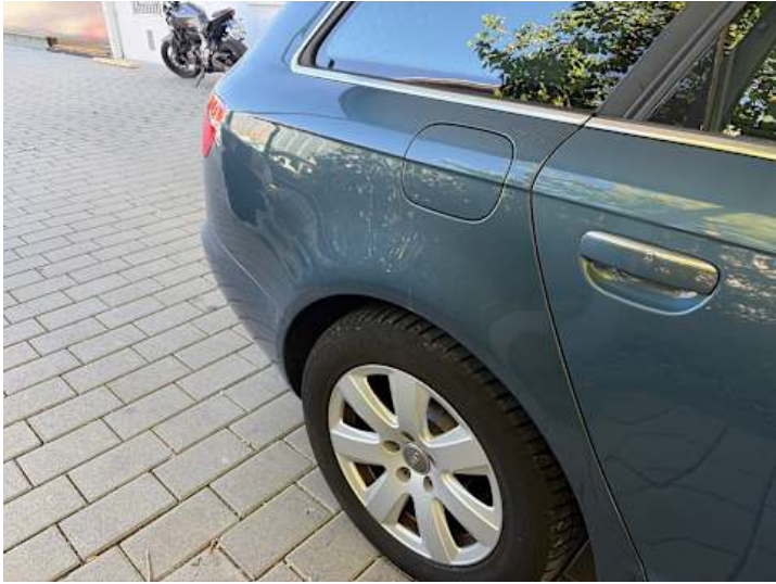
Seitenteil hinten rechts (Kratzer, Rost)
