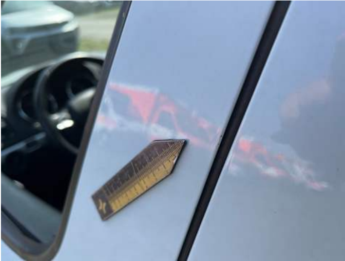
Fahrtür (Kratzer, Unsachgemäß instand gesetzt)
