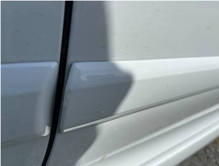
Beifahrtür (Kratzer, Unsachgemäß instand gesetzt)
