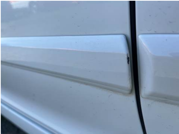
Fahrtür (Kratzer, Unsachgemäß instand gesetzt)
