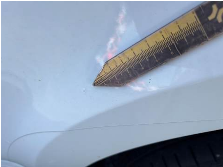
Türe hinten links (Rost)
