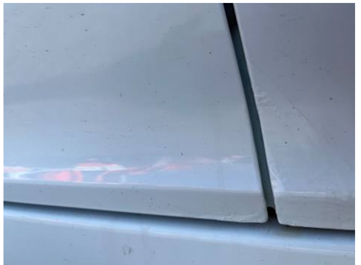
Fahrtür (Kratzer, Unsachgemäß instand gesetzt)
