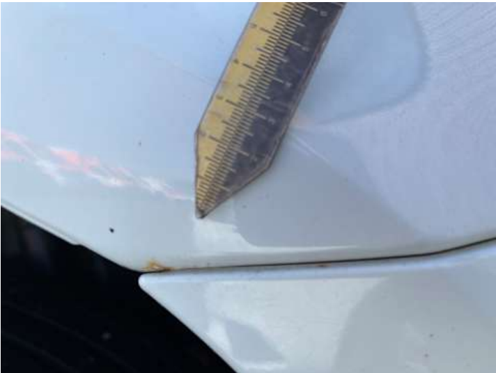
Seitenteil hinten links (Rost)
