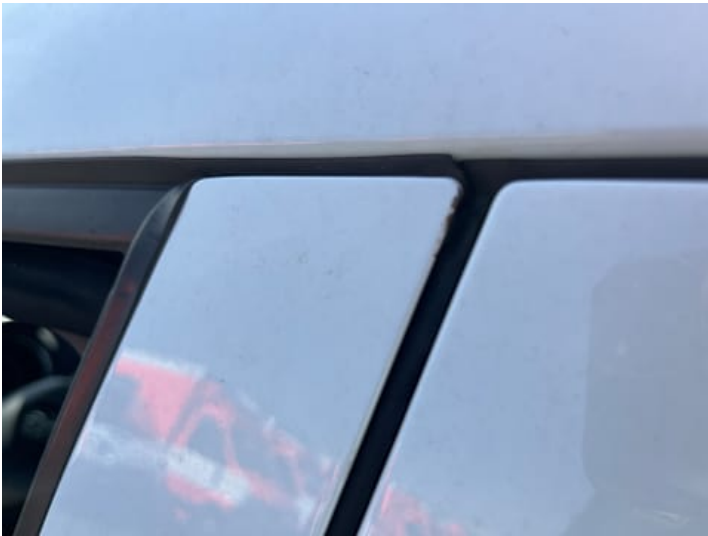
Fahrtür (Kratzer, Unsachgemäß instand gesetzt)
