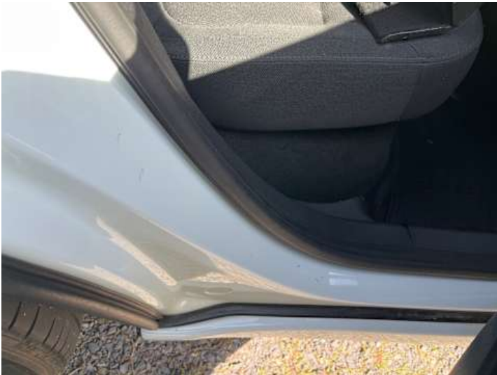
Schweller rechts (Kratzer, Delle)
