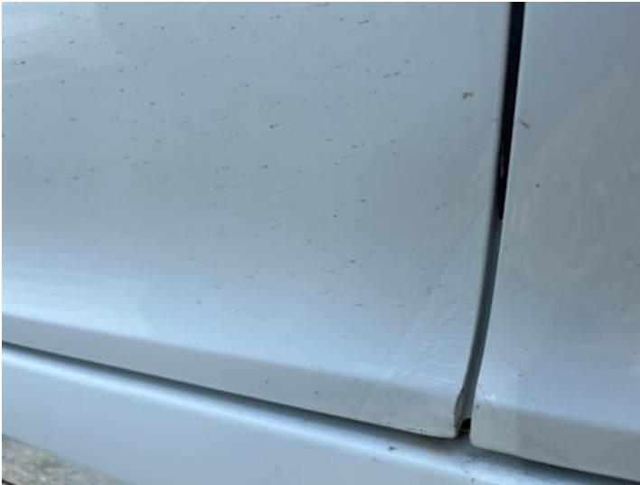
Türe hinten rechts (Lackschaden, Kratzer, Unsachgemäß instand gesetzt, Rost)
