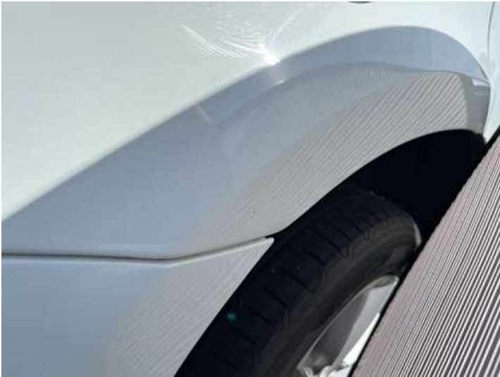
Seitenteil hinten rechts (Verformung)
