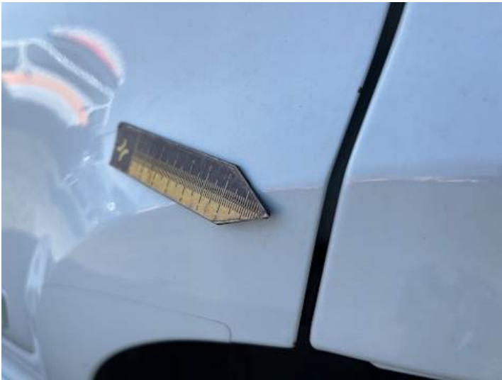
Türe hinten links (Rost, Lackschaden, Unsachgemäß instand gesetzt)
