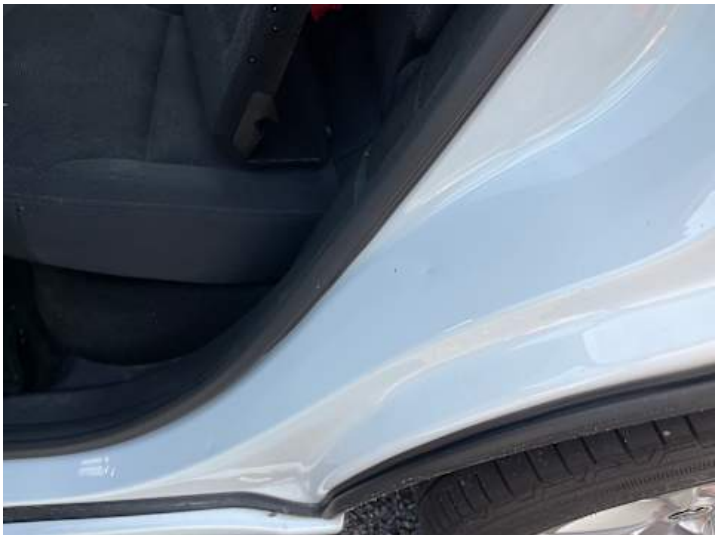
Schweller links (Kratzer, Delle)
