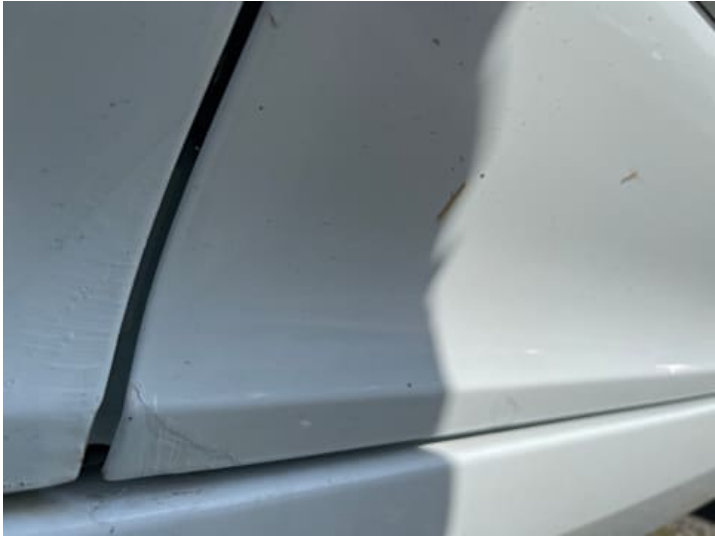
Beifahrtür (Kratzer, Unsachgemäß instand gesetzt)
