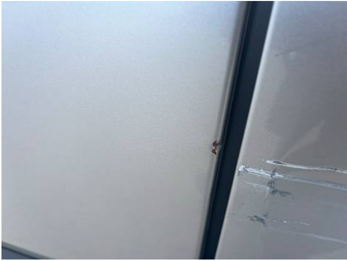
Seitenteil hinten rechts (Lackschaden, Rost)
