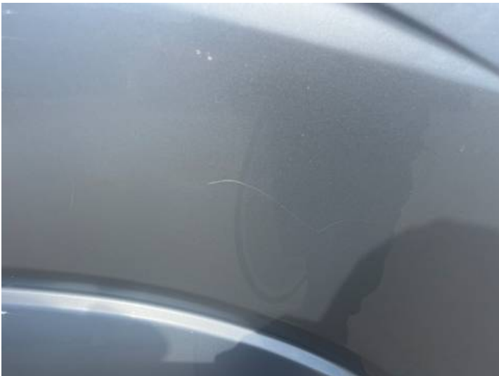
Kotflügel vorne rechts (Kratzer, Lackschaden)
