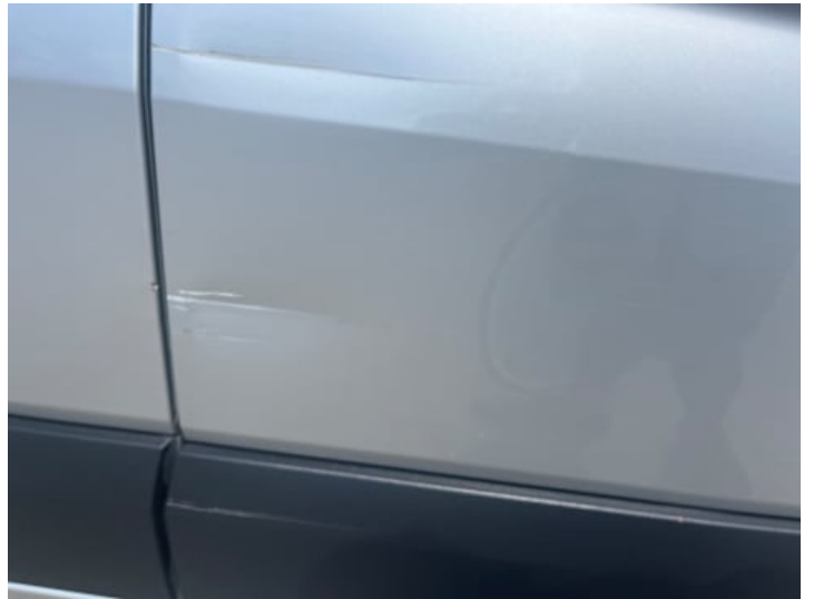
Türe hinten rechts (Kratzer, Lackschaden)
