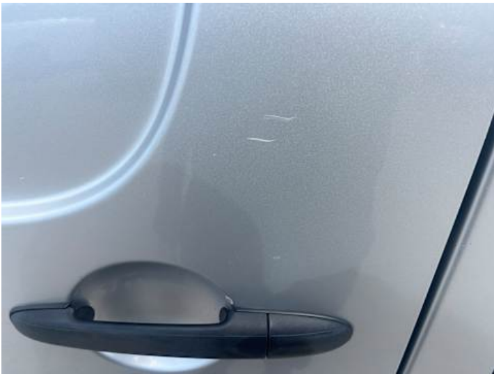
Türe hinten rechts (Kratzer, Lackschaden)
