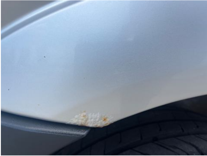
Seitenteil hinten rechts (Lackschaden, Rost)
