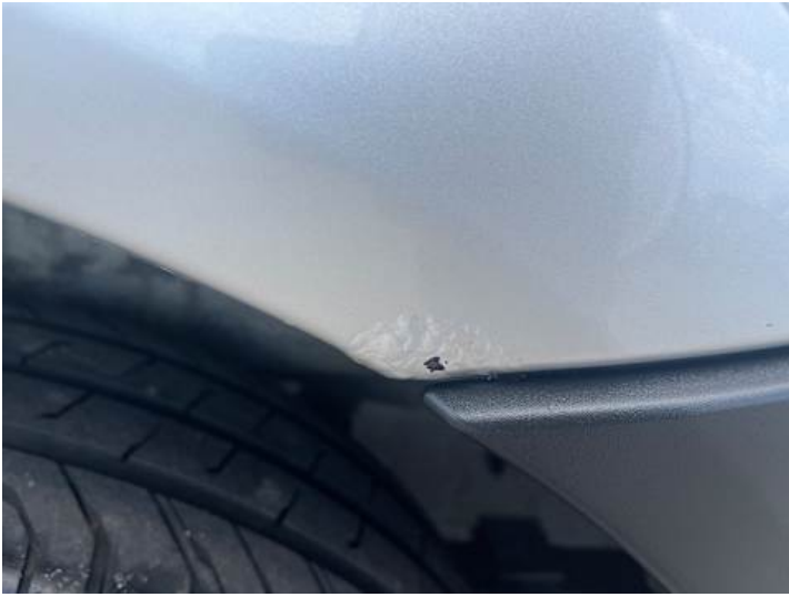
Seitenteil hinten rechts (Lackschaden, Rost)
