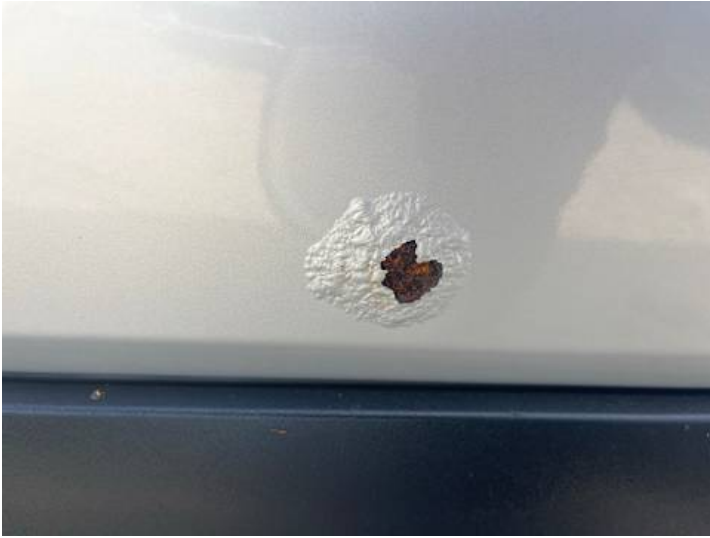
Seitenteil hinten links (Lackschaden, Rost)
