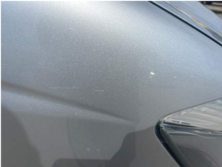
Kotflügel vorne rechts (Kratzer, Lackschaden)
