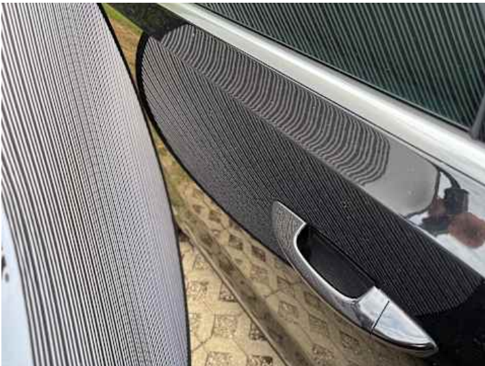
Türe hinten rechts (Kratzer, Delle)
