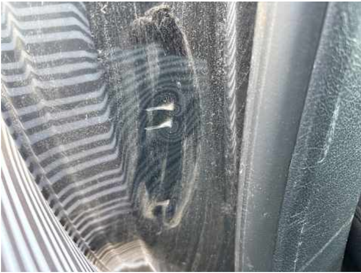
Schweller rechts (Kratzer, Delle)
