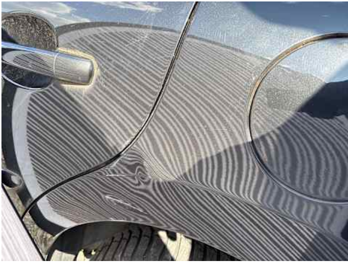
Seitenteil hinten links (Verformung, Kratzer)
