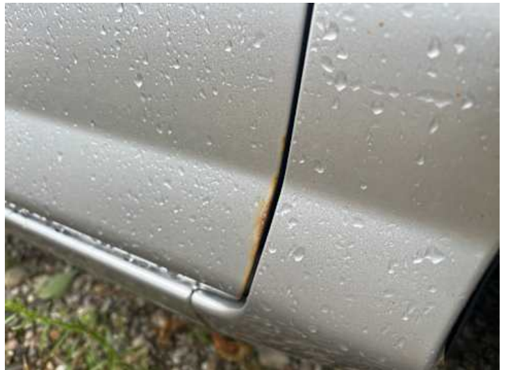
Beifahrtür (Rost, Lackschaden)
