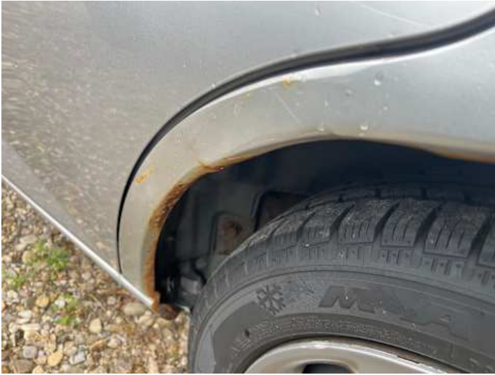
Seitenteil hinten links (Rost, Lackschaden)
