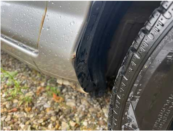
Kotflügel vorne rechts (Lackschaden, Verformung, Rost)
