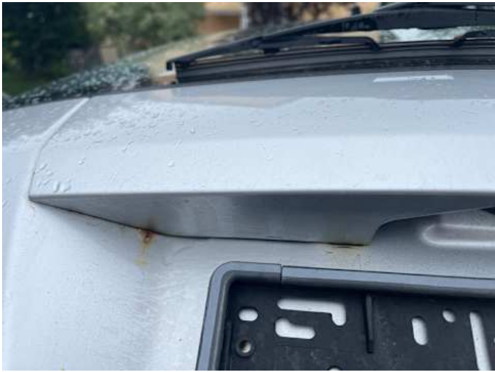
Heckklappe (Rost, Lackschaden)
