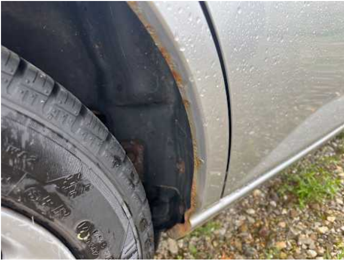
Seitenteil hinten rechts (Rost, Lackschaden)
