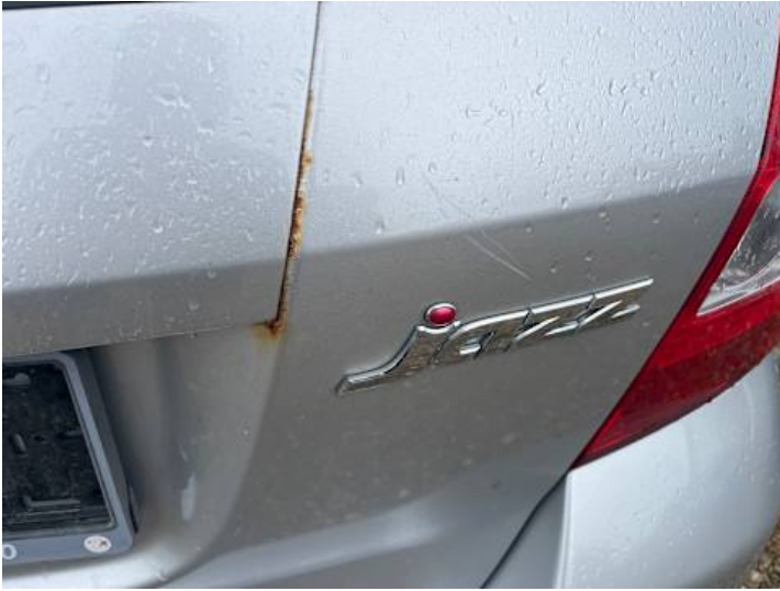
Heckklappe (Rost, Lackschaden)
