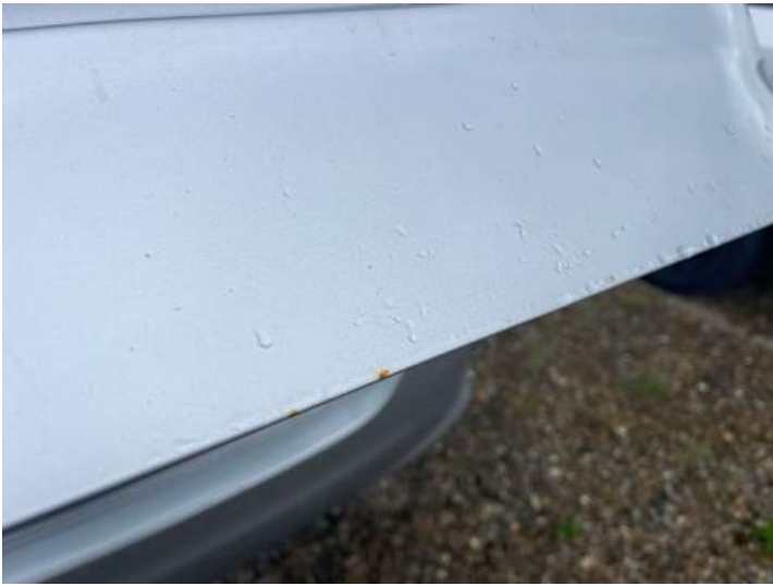
Heckklappe (Rost, Lackschaden)
