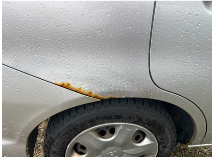
Seitenteil hinten rechts (Rost, Lackschaden)
