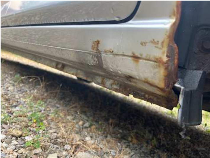
Schweller links (Rost)
