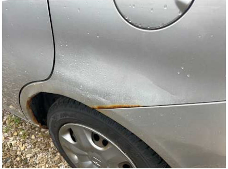
Seitenteil hinten links (Rost, Lackschaden)
