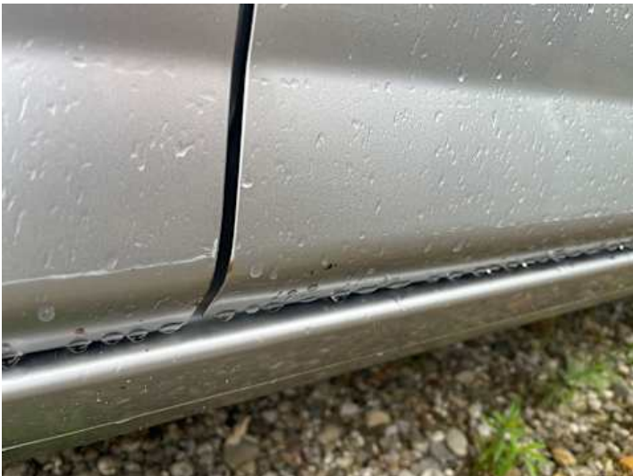
Beifahrtür (Rost, Lackschaden)
