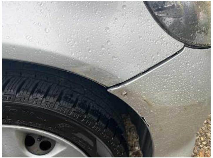
Kotflügel vorne rechts (Lackschaden, Verformung, Rost)
