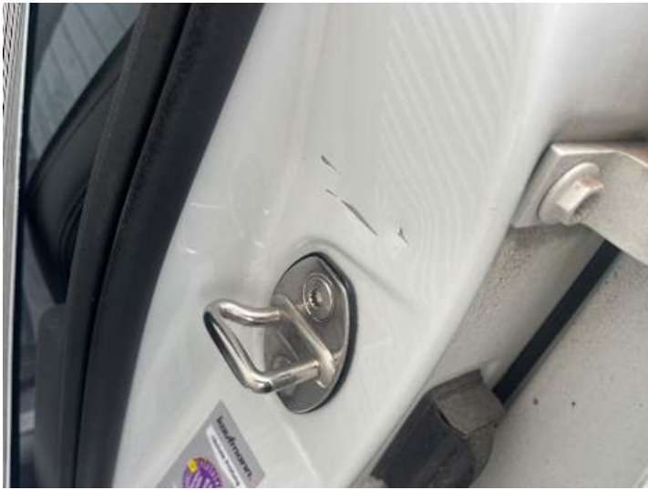
Fahrtür (Kratzer, Lackschaden, Delle)
