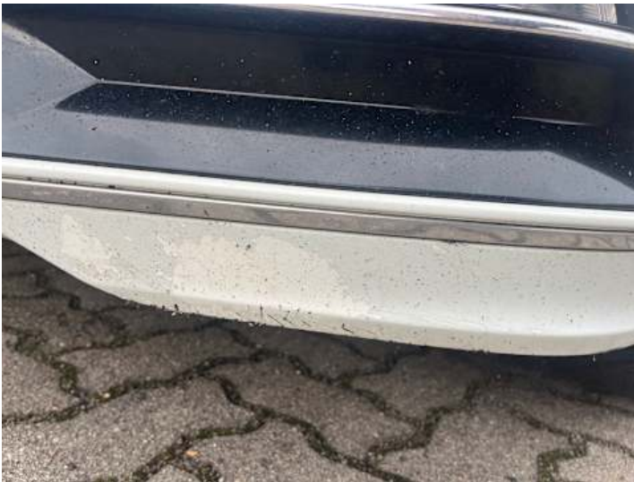
Stoßstange vorne (Unsachgemäß instand gesetzt, Lackschaden)
