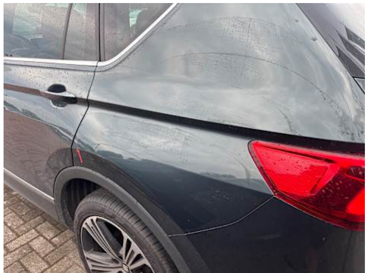
Seitenteil hinten links (Unsachgemäß instand gesetzt)
