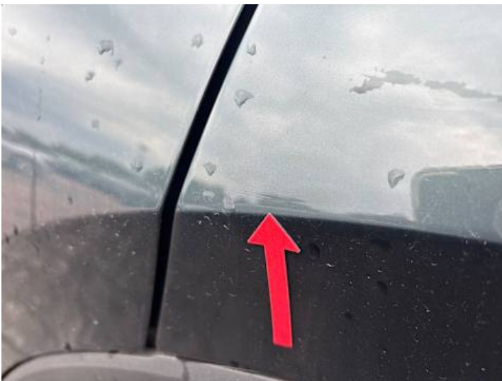
Seitenteil hinten links (Unsachgemäß instand gesetzt)
