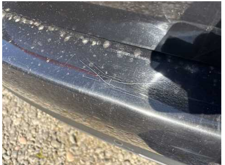
Stoßstange hinten (Riss/Bruch, Verformung)
