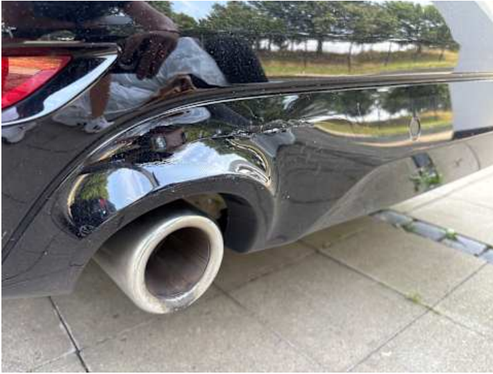
Stoßstange hinten (Kratzer, Lackschaden, Riss/Bruch)
