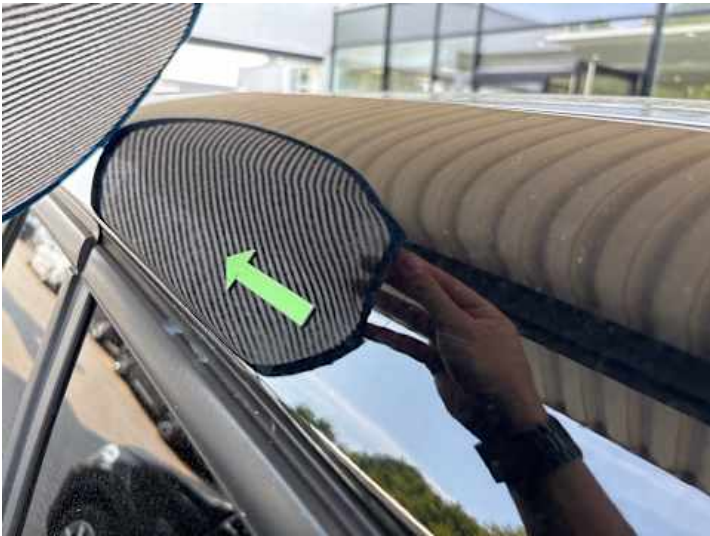
Seitenteil hinten links (Delle, Kratzer)
