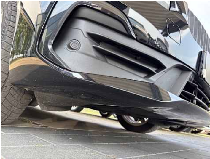
Stoßstange vorne (Steinschlag, Kratzer)
