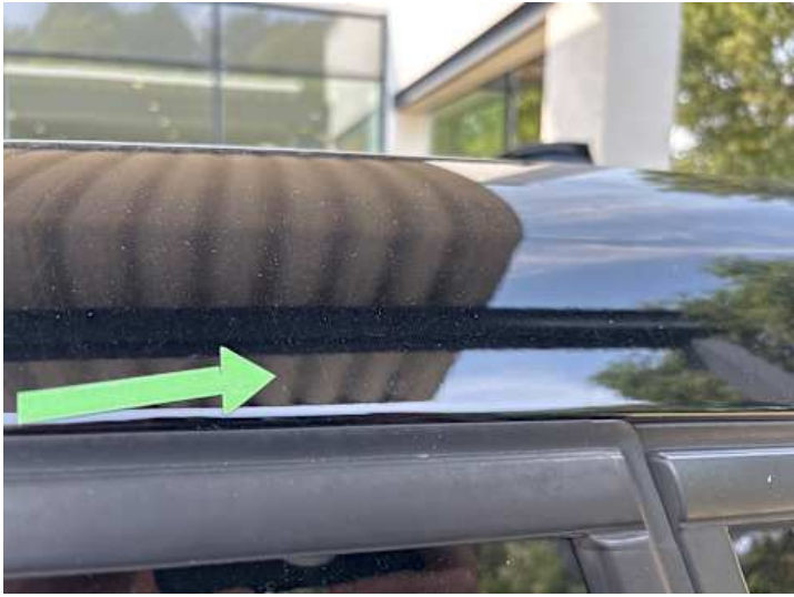
Seitenteil hinten links (Delle, Kratzer)
