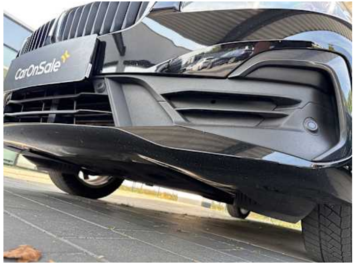
Stoßstange vorne (Steinschlag, Kratzer)
