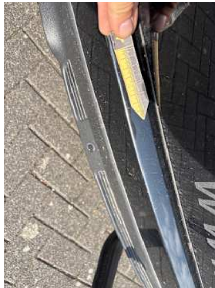
Stoßstange hinten (Lackschaden, Kratzer)
