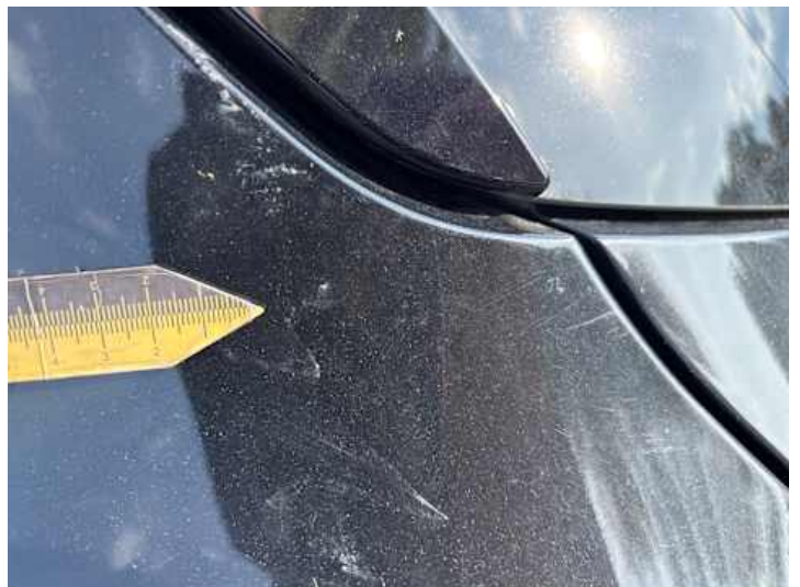
Seitenteil hinten links (Kratzer)
