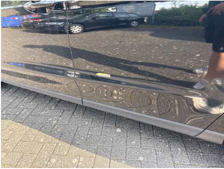
Türe hinten links (Lackschaden)
