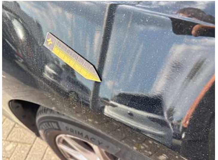
Kotflügel vorne rechts (Kratzer)
