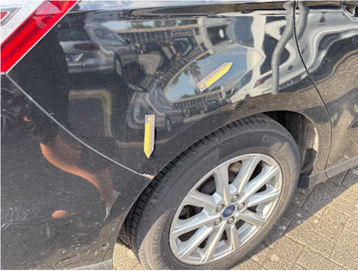
Seitenteil hinten rechts (Lackschaden, Rost)
