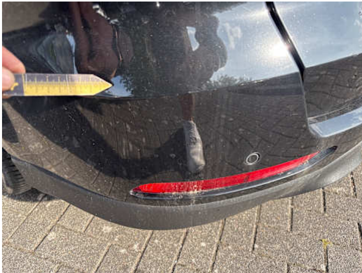
Stoßstange hinten (Lackschaden, Kratzer)
