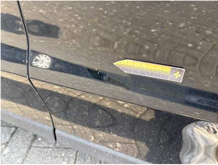
Türe hinten links (Lackschaden)
