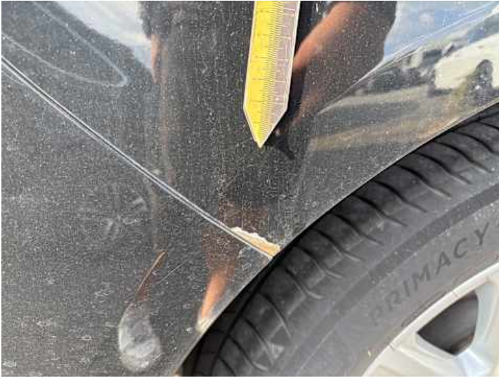
Seitenteil hinten rechts (Lackschaden, Rost)
