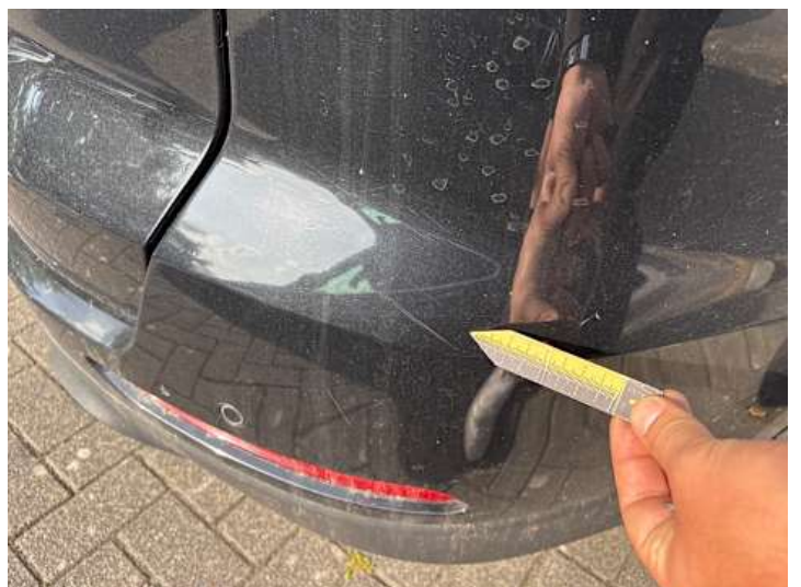
Stoßstange hinten (Lackschaden, Kratzer)
