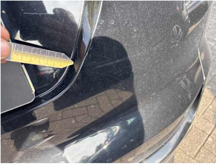
Heckklappe (Kratzer, Lackschaden)
