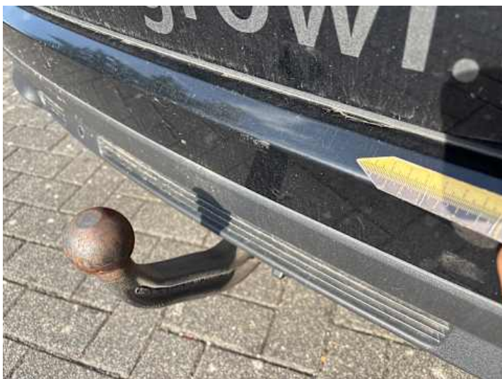
Stoßstange hinten (Lackschaden, Kratzer)
