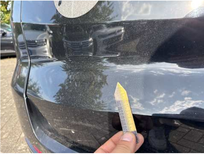
Heckklappe (Kratzer, Lackschaden)
