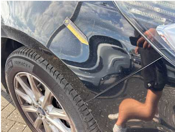
Kotflügel vorne rechts (Steinschlag)
