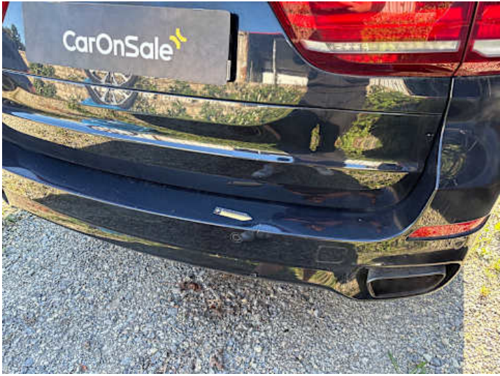
Stoßstange hinten (Riss/Bruch, Verformung)
