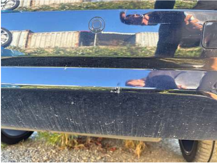
Stoßstange hinten (Riss/Bruch, Verformung)
