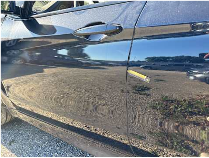
Fahrtür (Ausgeblichen/Matt, Unsachgemäß instand gesetzt)
