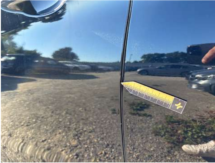
Fahrtür (Ausgeblichen/Matt, Unsachgemäß instand gesetzt)
