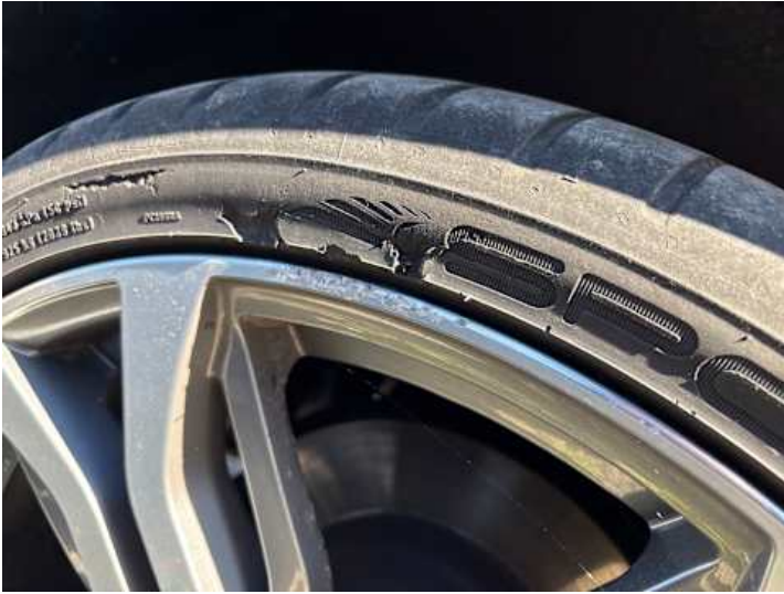
Rad (Kerben, Riss/Bruch)
