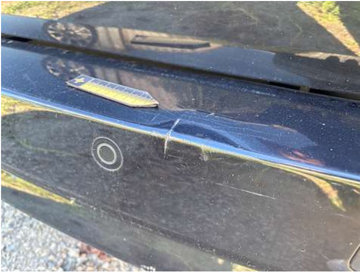
Stoßstange hinten (Riss/Bruch, Verformung)
