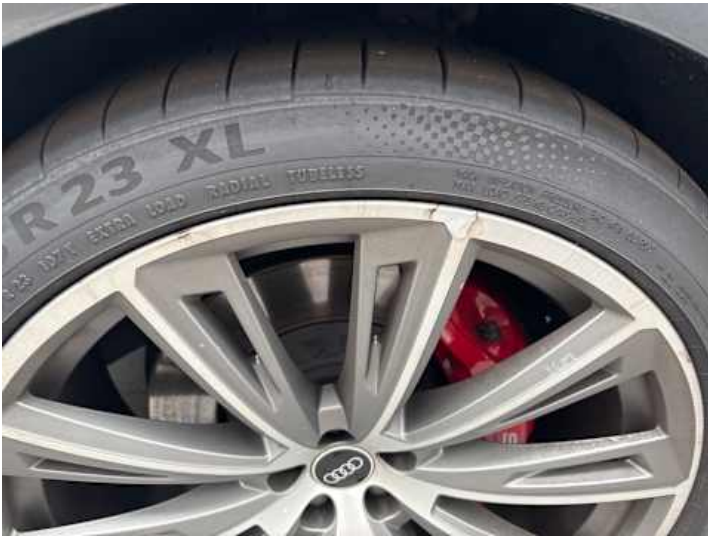
Rad (Anderer Schaden): Lackschaden
