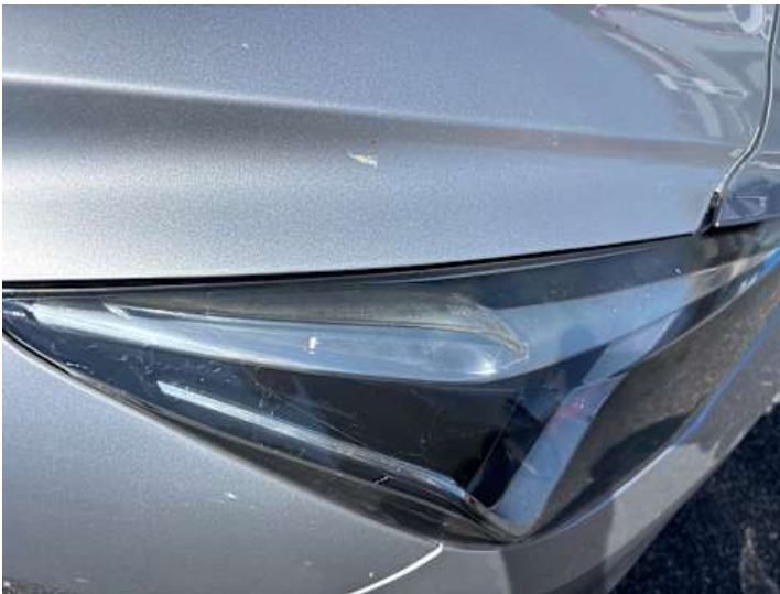
Scheinwerfer (rechts) (Blind, Anderer Schaden): Lackschaden
