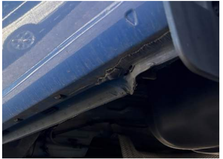
Schweller links (Verformung)
