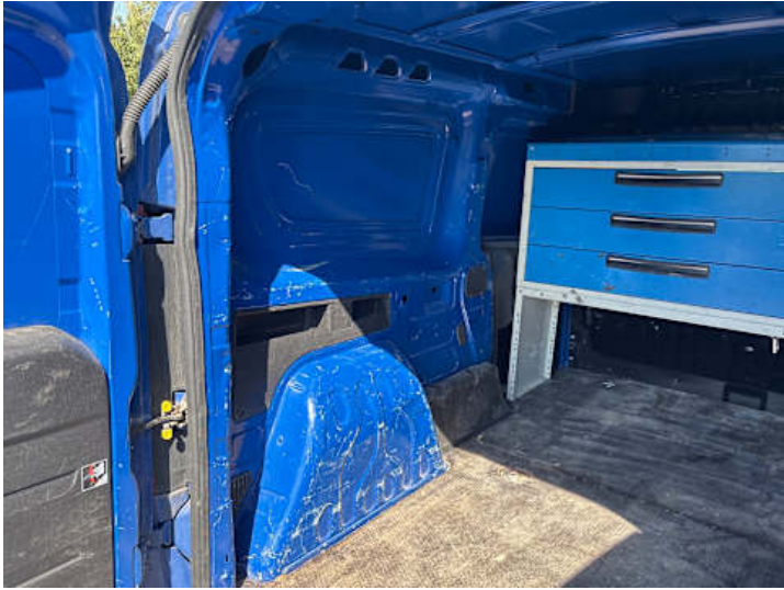
Innenraum (Diverse Schäden, Kratzer)
