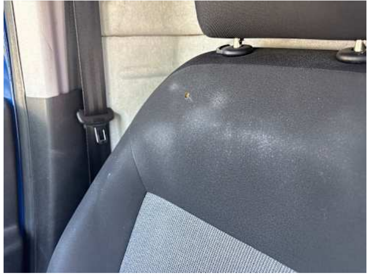
Innenraum (Riss/Bruch, Brandloch)
