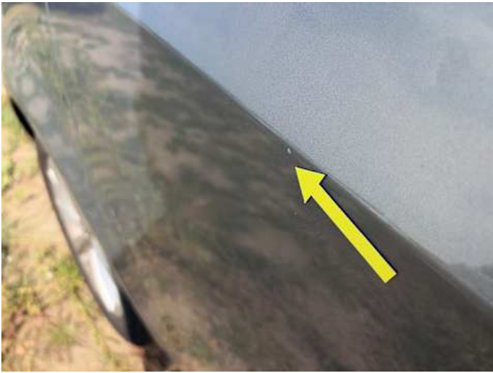
Türe hinten rechts (Delle, Kratzer)
