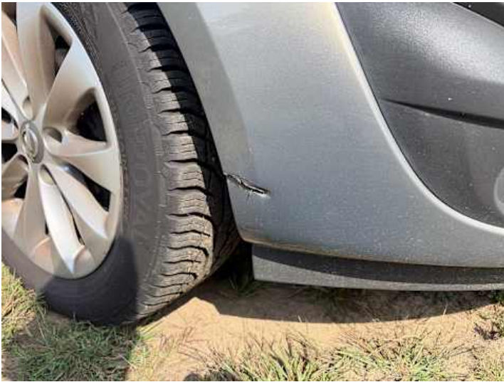
Stoßstange vorne (Riss/Bruch)
