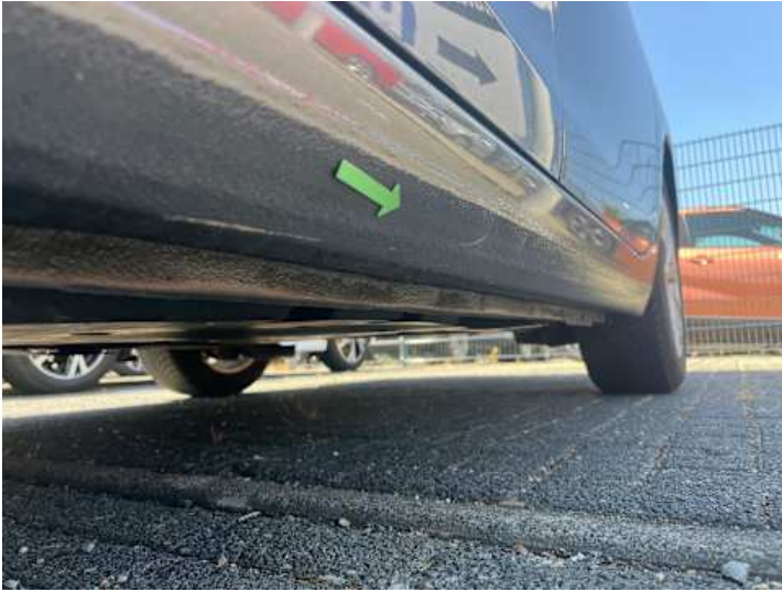
Schweller links (Delle, Kratzer)
