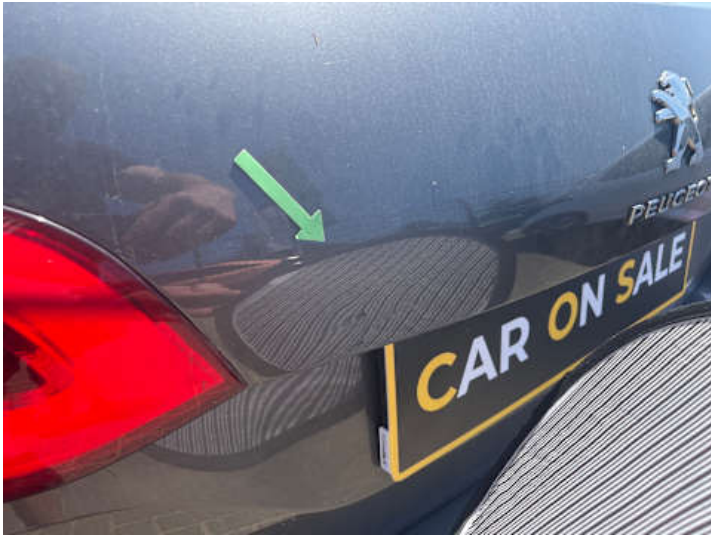
Heckklappe (Delle, Kratzer)
