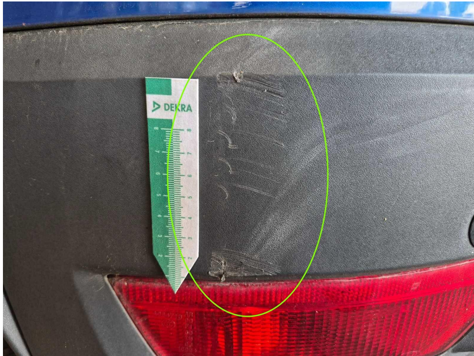
Bild 17 : Stoßfängerverkleidung hinten links- und rechtsseitig massiv verschrammt
