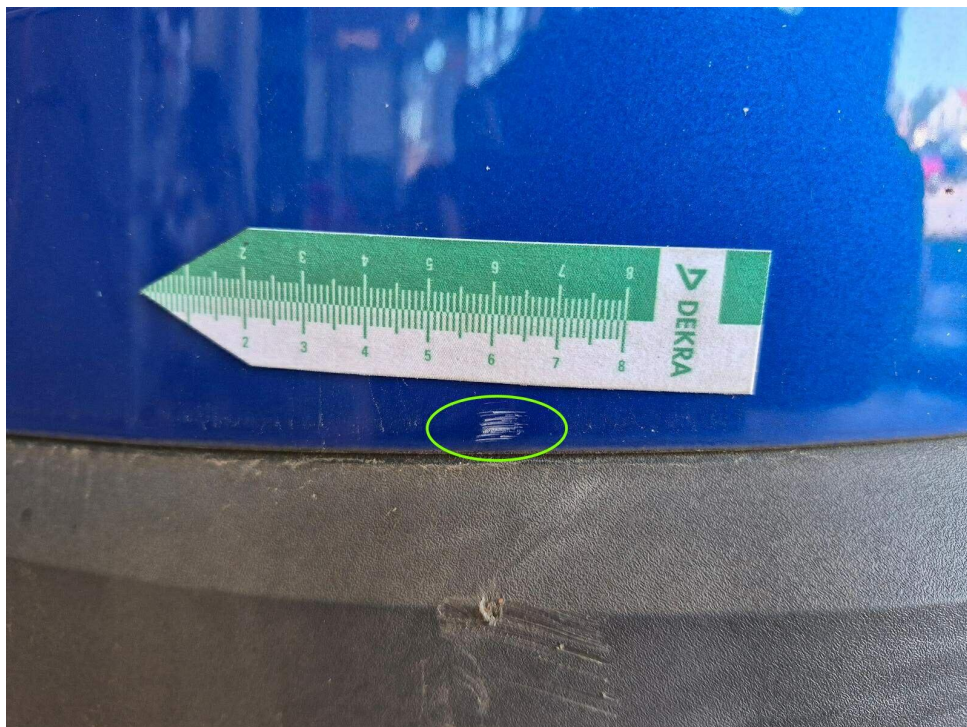
Bild 16 : Stoßfängerabdeckung hinten links verschrammt
