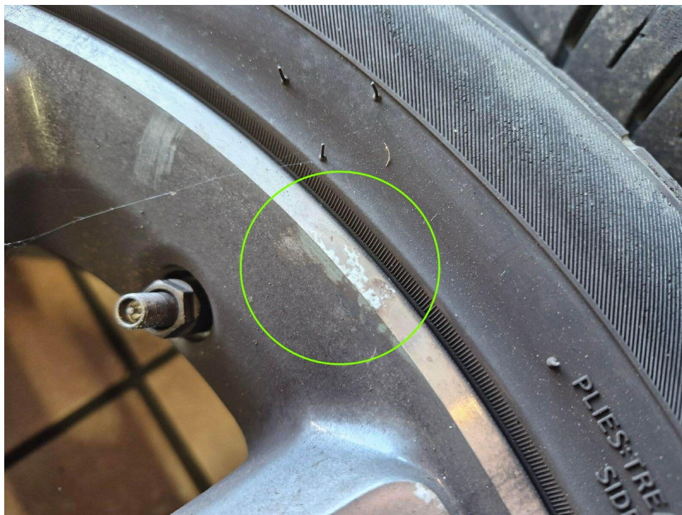
Bild 7 : Scheibenrad vorn rechts weist chemische Anätzung auf, Wertminderung (Sommerradsatz)
