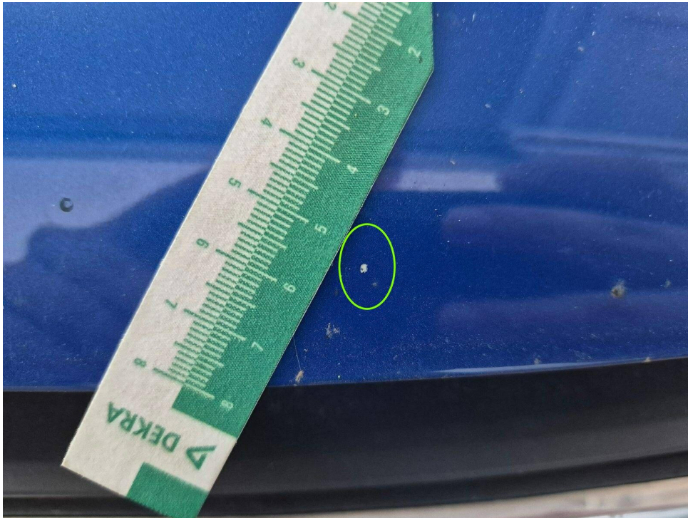
Bild 13 : Frontbereich weist vereinzelt kleinere Steinschläge auf
