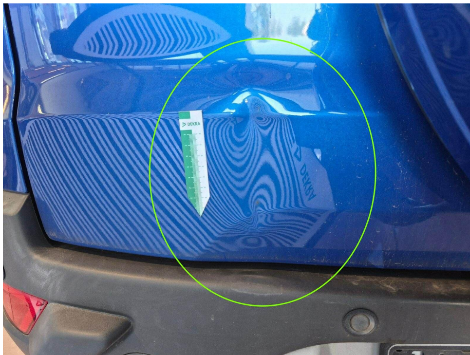
Bild 19 : Heckklappe linksseitig unterhalb scharfkantig eingedrückt
