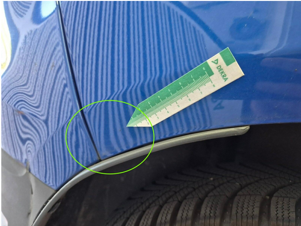
Bild 23 : Seitenwand hinten rechts leicht deformiert und zerkratzt
