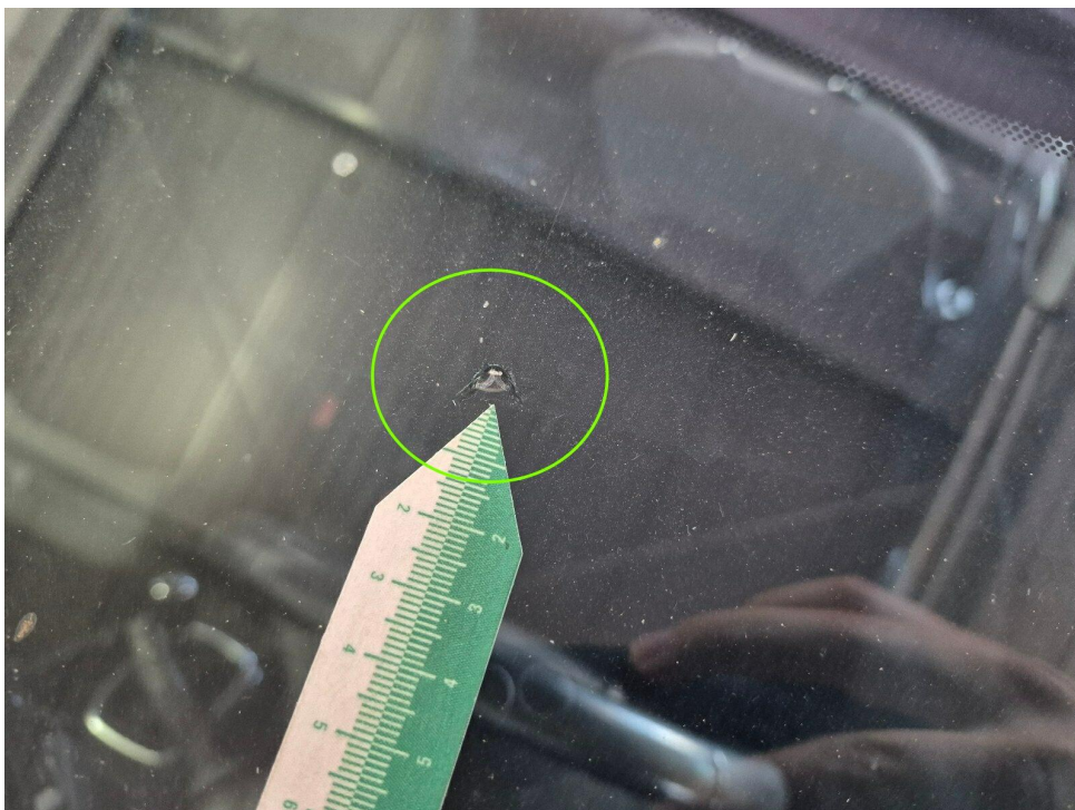
Bild 14 : Frontscheibe Steinschlag mit Rissbildung
