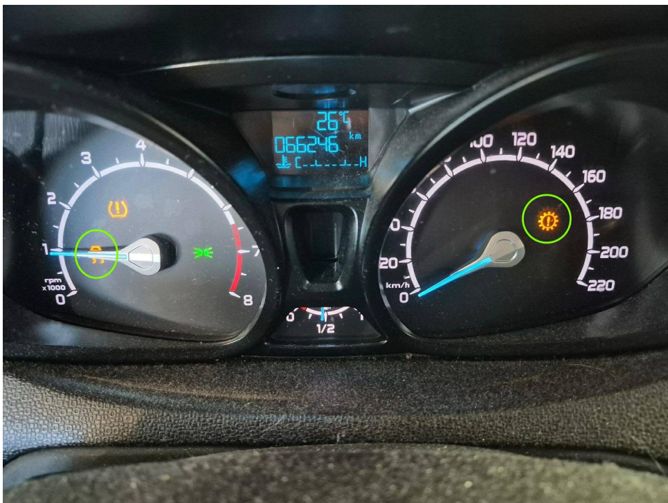
Bild 4 : Kombiinstrument Antriebsstrang Fehlermeldung im Kombiinstrument
