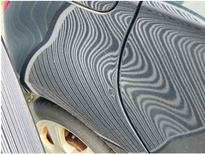
Seitenteil hinten rechts (Delle, Kratzer)
