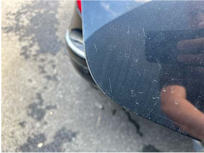
Heckklappe (Rost, Kratzer)
