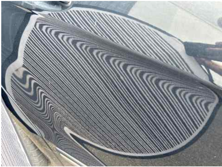
Türe hinten rechts (Rost, Delle, Kratzer)
