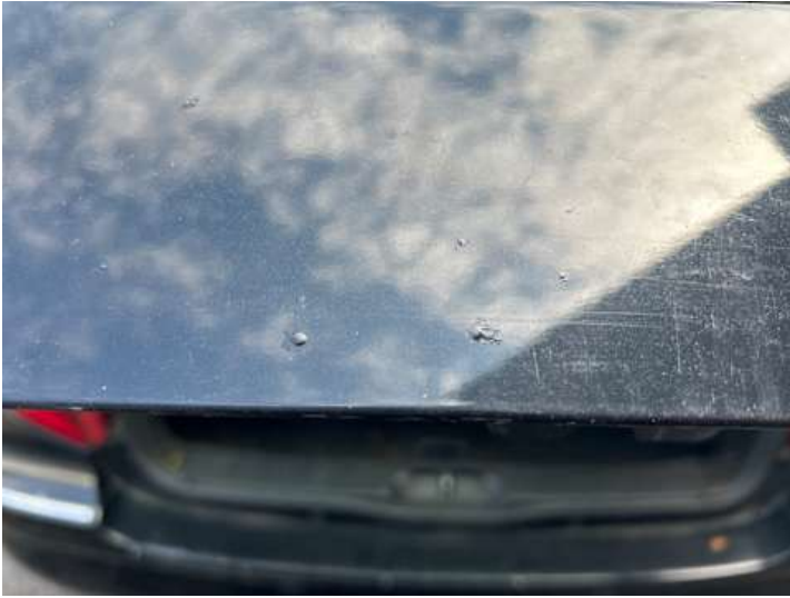
Heckklappe (Rost, Kratzer)
