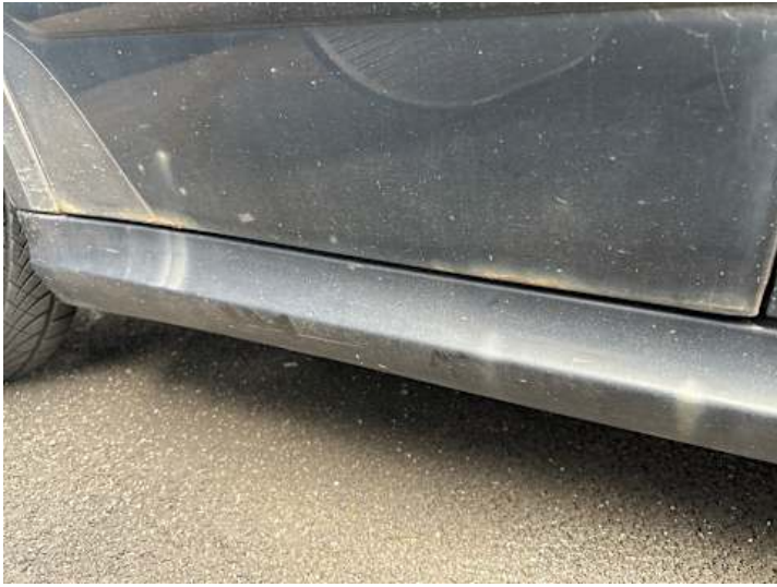
Türe hinten rechts (Rost, Delle, Kratzer)
