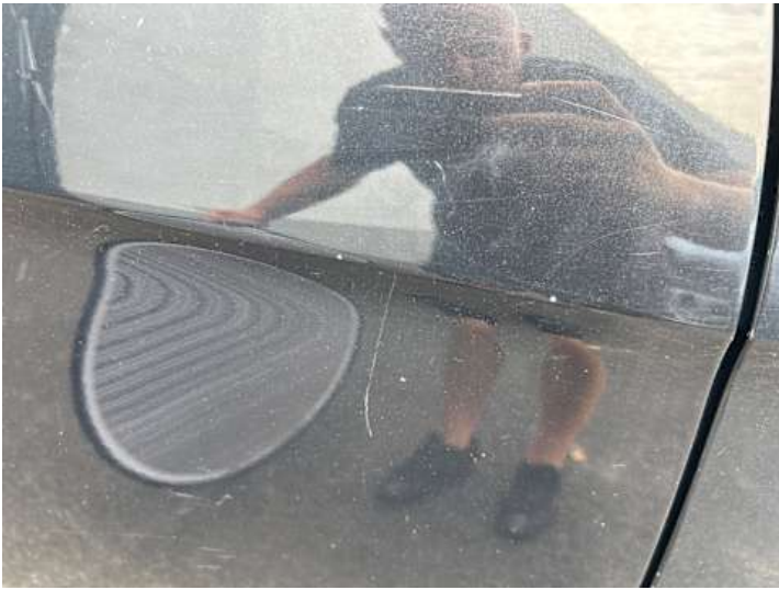
Türe hinten rechts (Rost, Delle, Kratzer)
