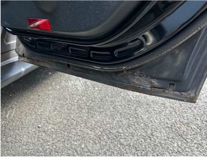
Türe hinten rechts (Rost, Delle, Kratzer)
