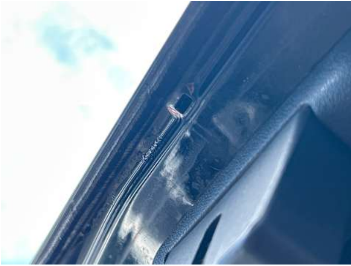
Heckklappe (Rost, Kratzer)
