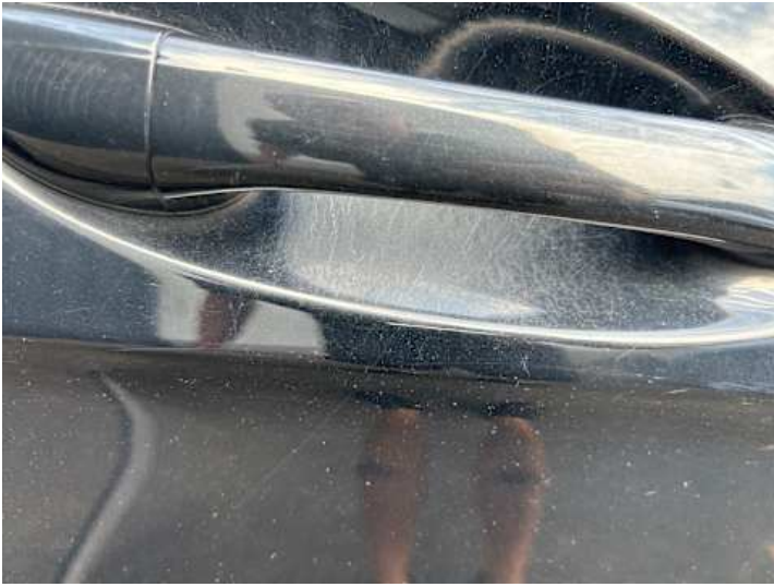
Türe hinten rechts (Rost, Delle, Kratzer)
