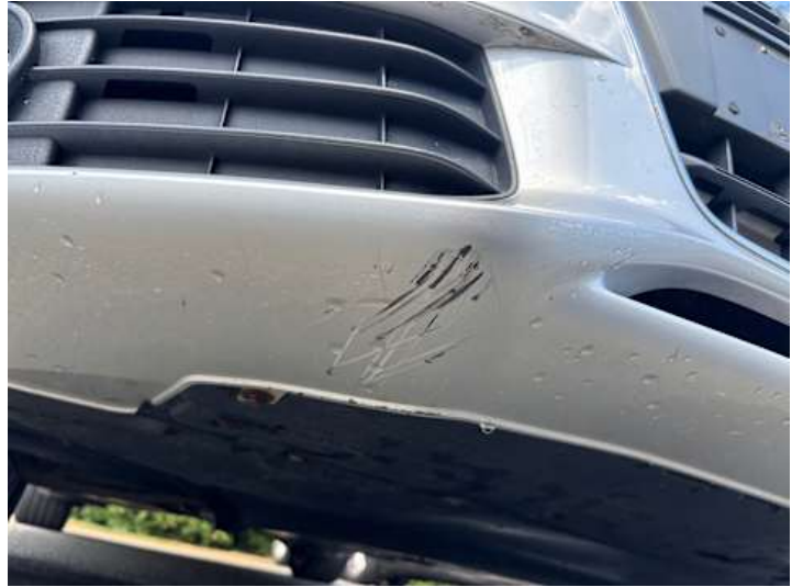
Stoßstange vorne (Kratzer, Lackschaden)
