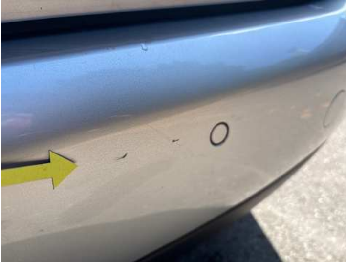
Stoßstange hinten (Kratzer, Lackschaden)
