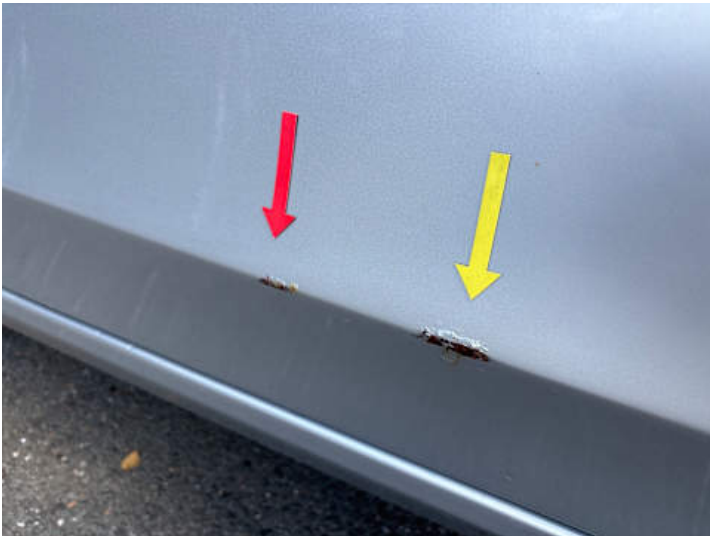
Beifahrertür (Rost, Lackschaden)
