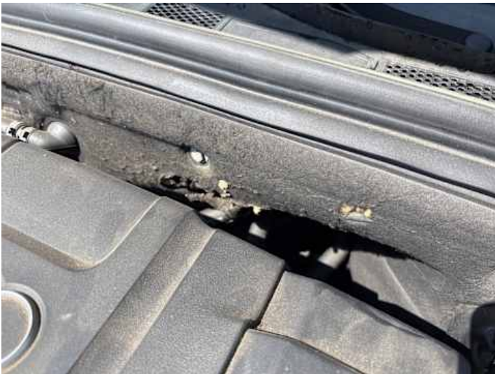
Motorhaube (Anderer Schaden): Dämmmatte beschädigt
