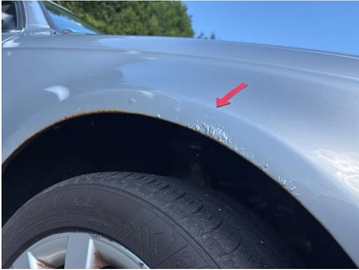
Kotflügel vorne rechts (Rost)
