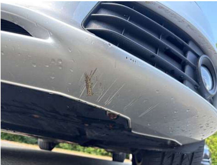
Stoßstange vorne (Kratzer, Lackschaden)
