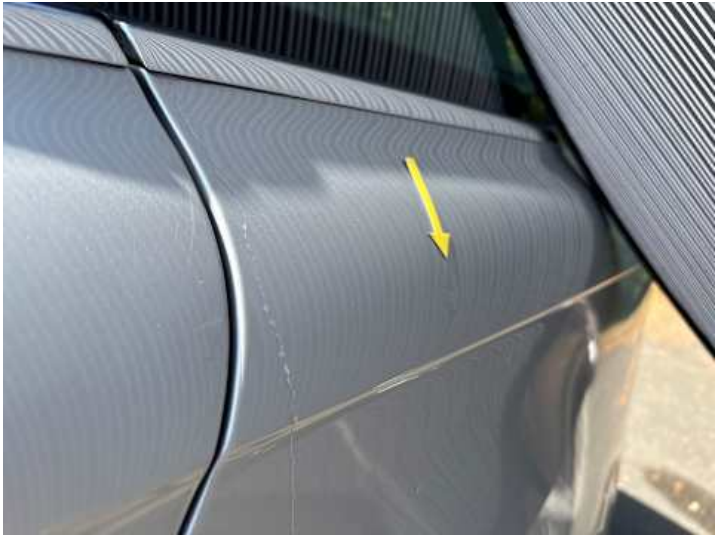
Seitenteil hinten links (Delle)
