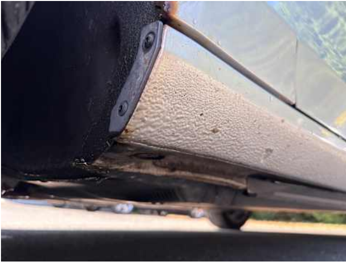
Schweller links (Rost)
