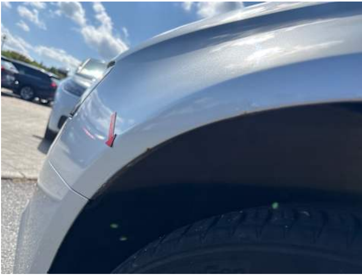
Kotflügel vorne links (Rost, Lackschaden)
