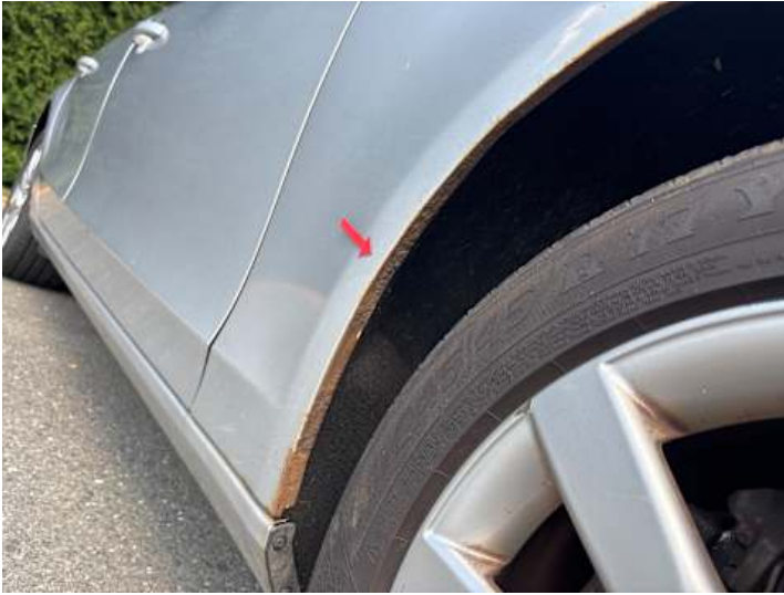
Kotflügel vorne rechts (Rost)
