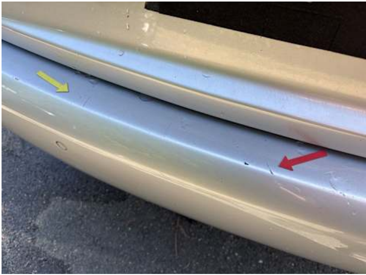
Stoßstange hinten (Kratzer, Lackschaden)
