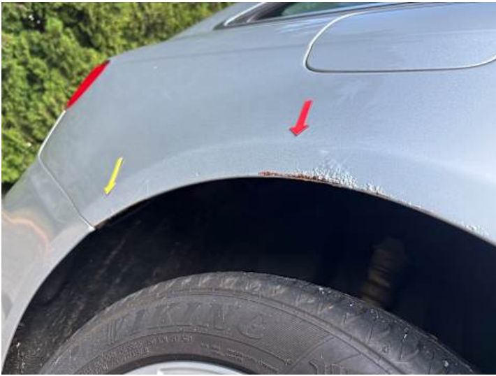
Seitenteil hinten rechts (Lackschaden, Rost)
