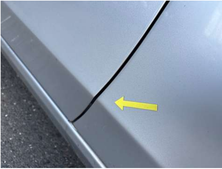
Kotflügel vorne rechts (Spaltmaße ungenau)
