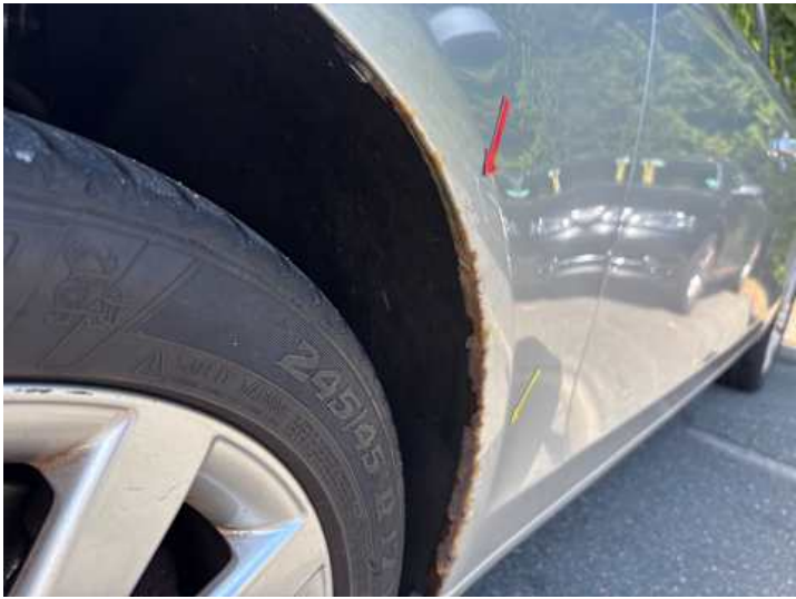
Kotflügel vorne links (Rost)
