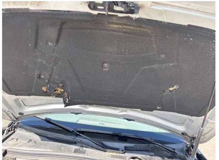
Motorhaube (Anderer Schaden): Dämmmatte beschädigt
