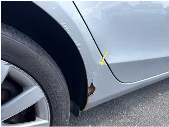
Seitenteil hinten rechts (Lackschaden, Rost)
