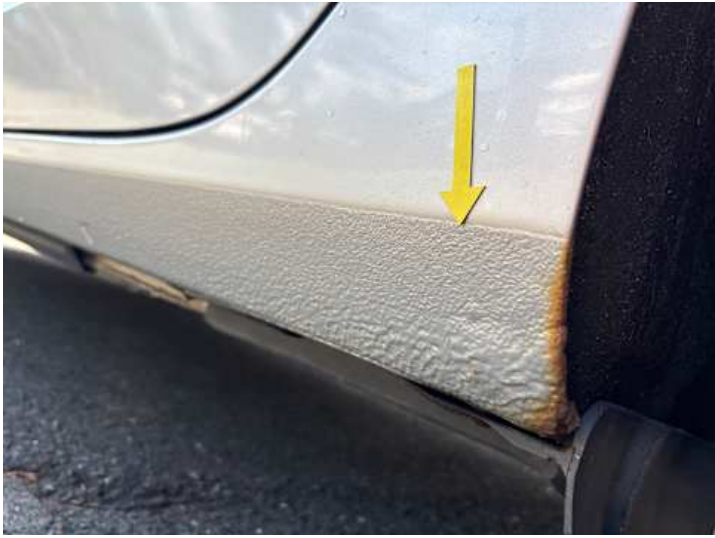
Schweller links (Rost)
