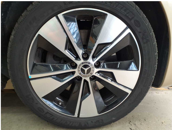
Rad/Reifen: Leichtmetallfelge vorn rechts (18" Glanzgedreht) - verkratzt / verschürft - erneuern
