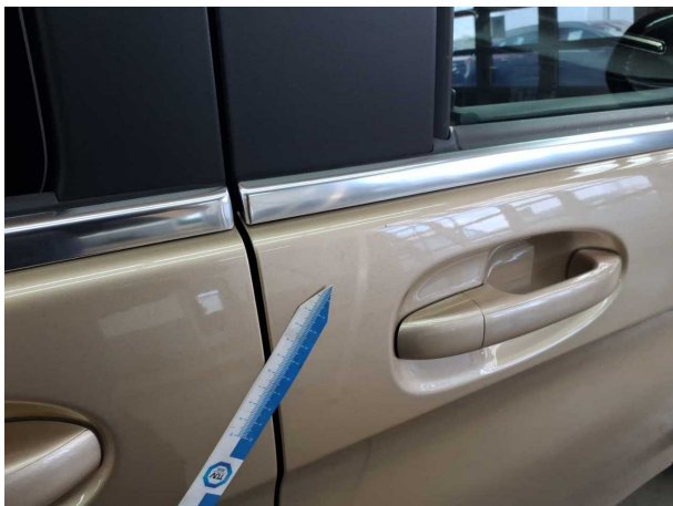
Tür vorn rechts: Tür - Delle(n) - Smart Repair
