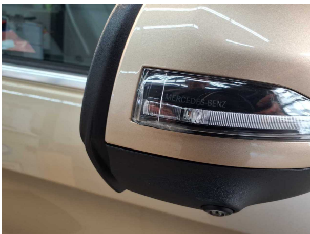
Blinkeuchte: Spiegel rechts - verkratzt / verschürft - erneuern
