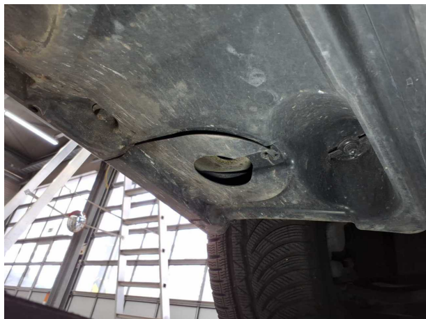
Schweller links: Wagenheberaufnahme vorn - fehlt - erneuern
