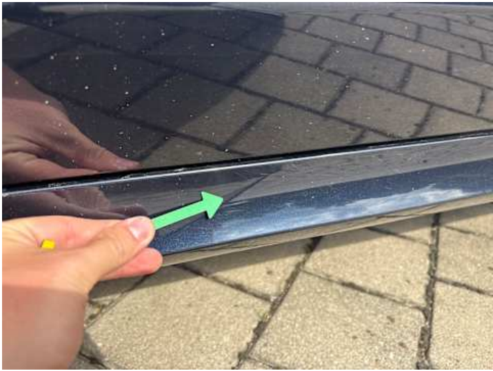
Schweller links (Kratzer)
