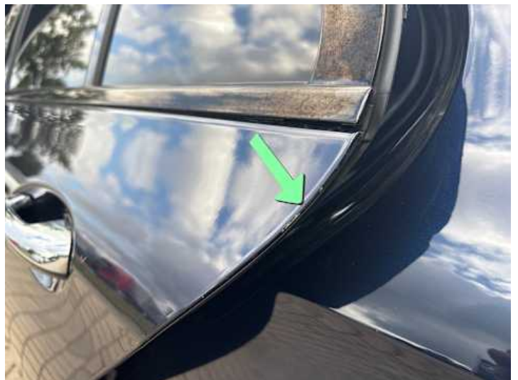
Türe hinten links (Lackschaden, Anderer Schaden): Leiste ausgeblitten
