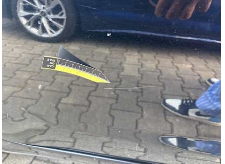
Türe hinten rechts (Kratzer, Lackschaden)
