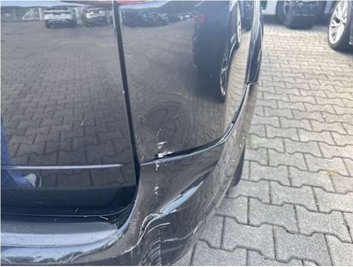
Seitenteil hinten rechts (Delle, Kratzer, Lackschaden, Verformung, Spaltmaße ungenau)
