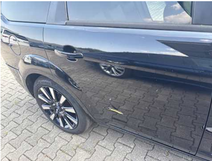
Türe hinten rechts (Kratzer, Lackschaden)
