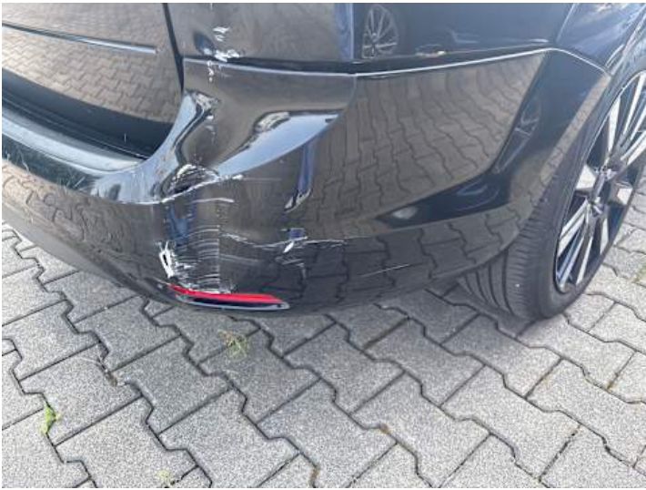
Stoßstange hinten (Lackschaden, Delle, Riss/Bruch, Verformung)
