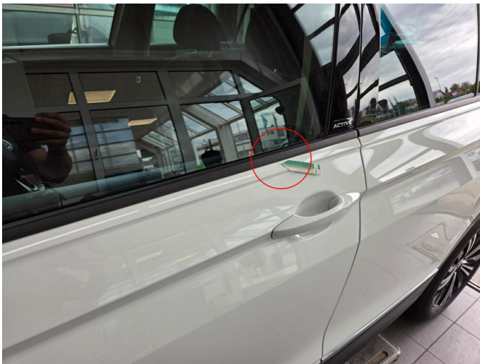
Bild 9: Außen, Tür vorne links - Lackierung oberhalb, verschrammt, smart repair
