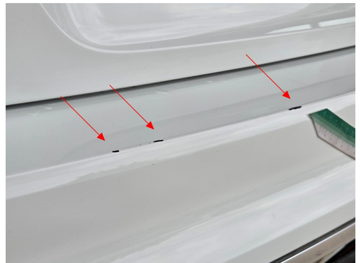
Bild 4: Außen, Stoßfänger hinten - Ladekante / Lackierung, mehrf. verschrammt, smart repair
