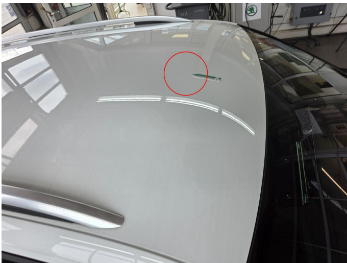
Bild 11: Außen, Dach, eingedellt, drücken
