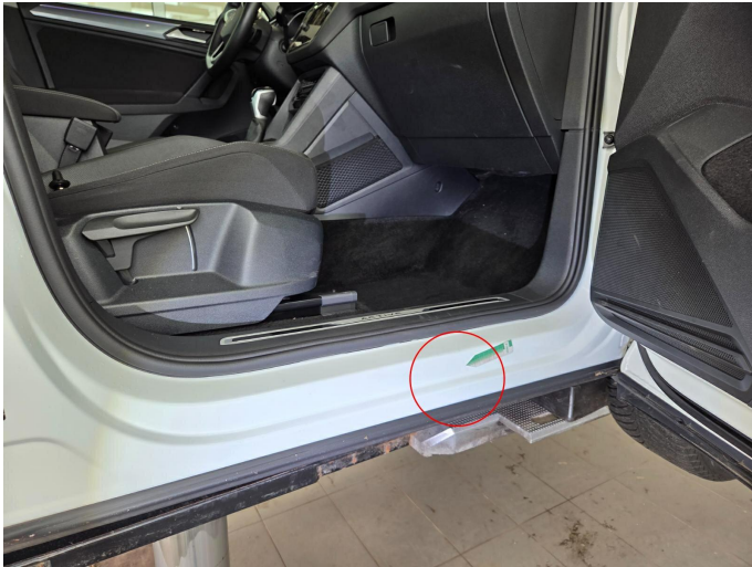
Bild 5: Außen, Tür vorne rechts - Einstieg, eingedellt, drücken
