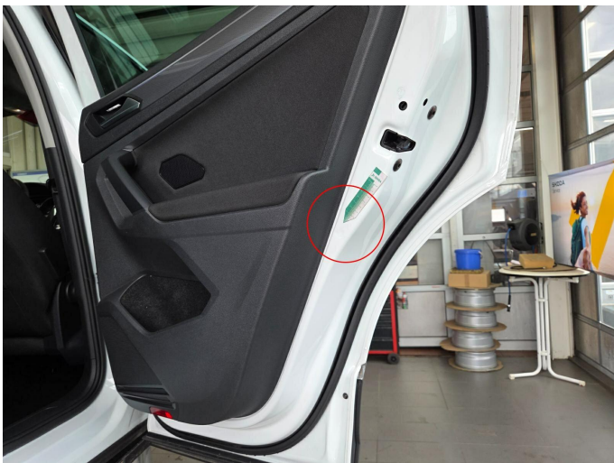
Bild 7: Außen, Tür hinten rechts - Türrahmen, eingedellt, drücken
