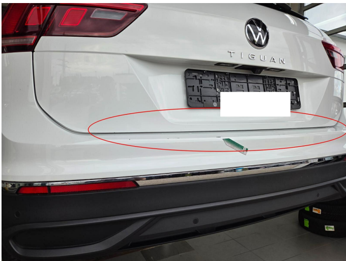
Bild 3: Außen, Stoßfänger hinten - Ladekante / Lackierung, mehrf. verschrammt, smart repair
