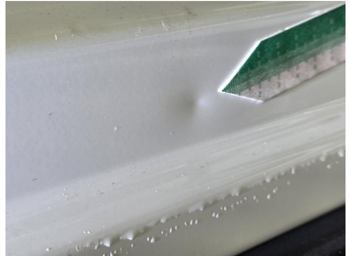
Bild 6: Außen, Tür vorne rechts - Einstieg, eingedellt, drücken
