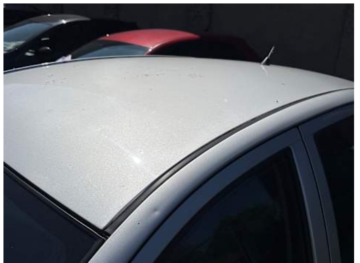
Dach (Delle, Anderer Schaden): Antenne beschädigt / Hagelschaden
