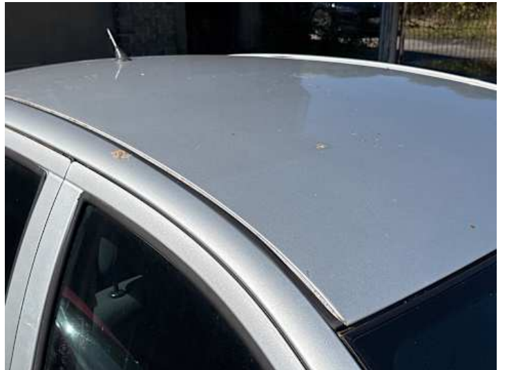
Dach (Delle, Anderer Schaden): Antenne beschädigt / Hagelschaden
