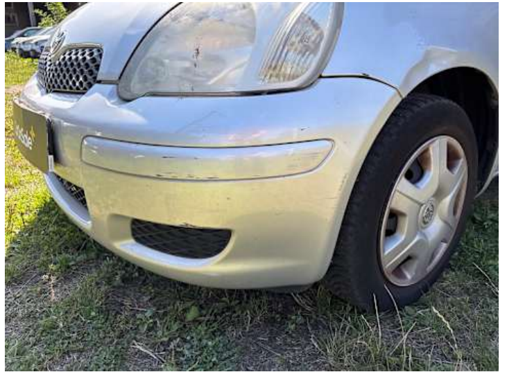
Stoßstange vorne (Kratzer, Lackschaden)
