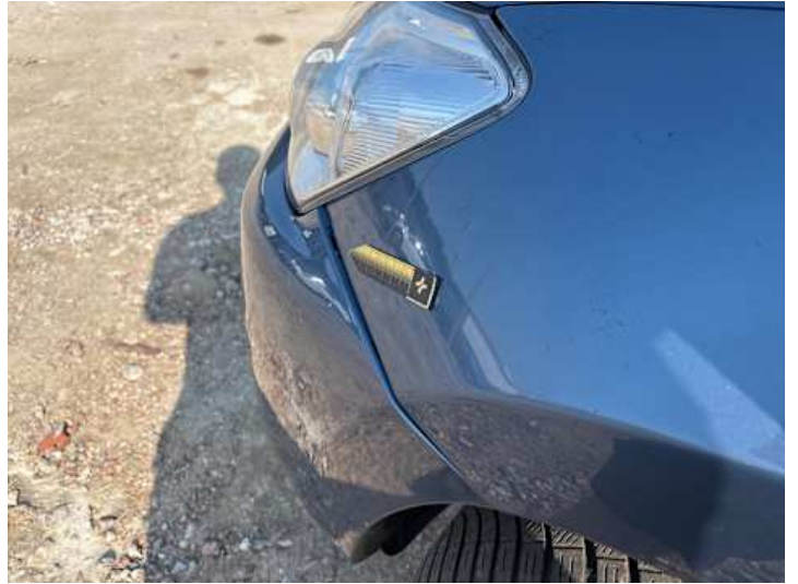
Stoßstange vorne (Spaltmaße ungenau)
