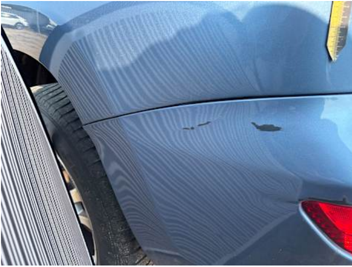
Stoßstange hinten (Lackschaden, Verformung)
