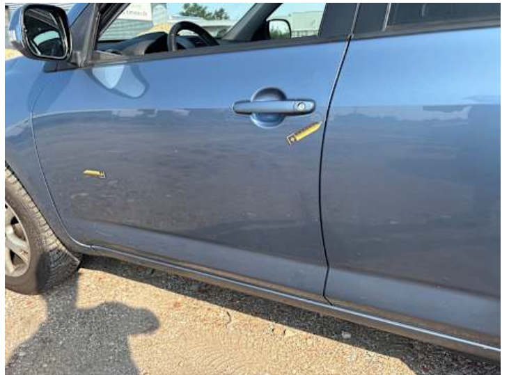
Fahrtür (Kratzer, Delle)
