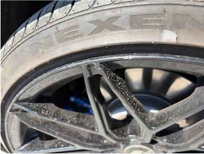
Rad (Kratzer, Riss/Bruch)
