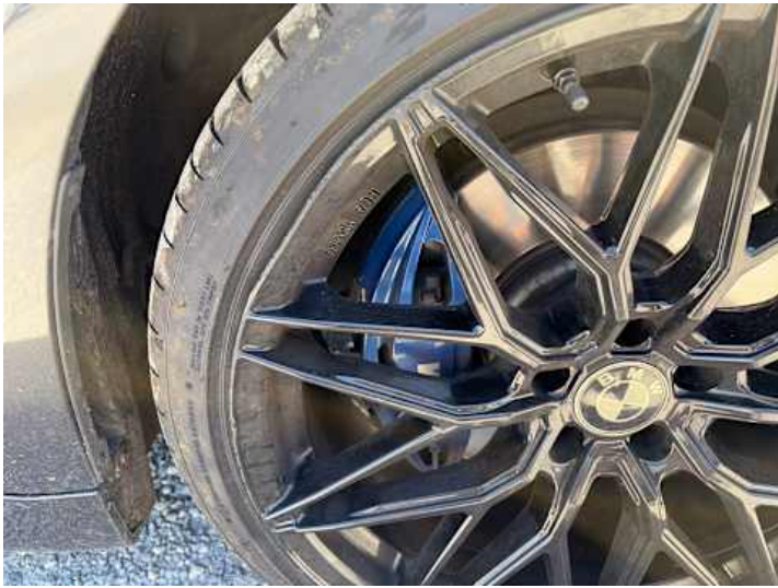
Rad (Kratzer, Verformung)
